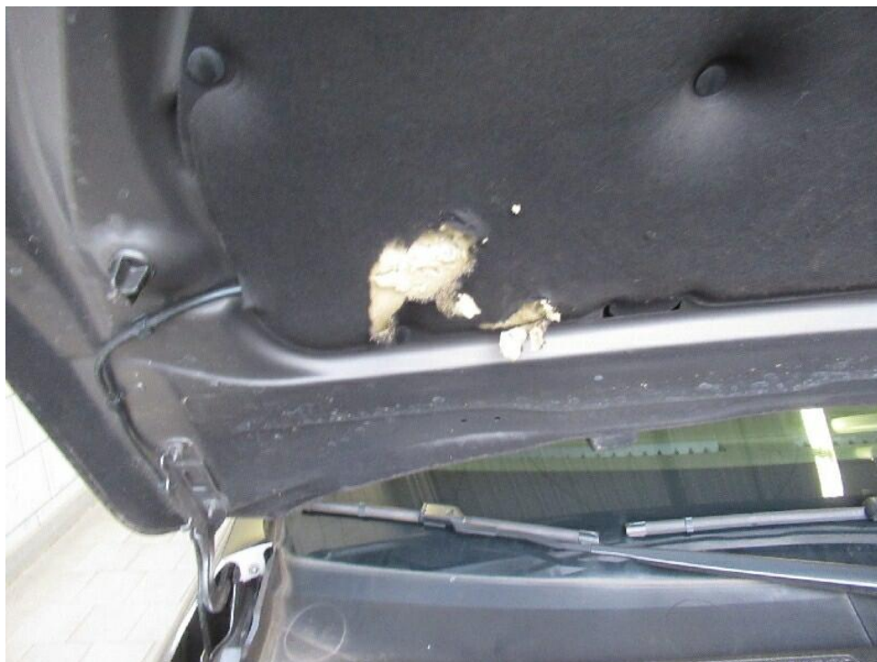
Bild 13 : Dämmmatte Motorraum aufgerissen
