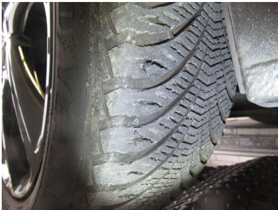
Bild 21 : Reifen v.r. Profilablösung
