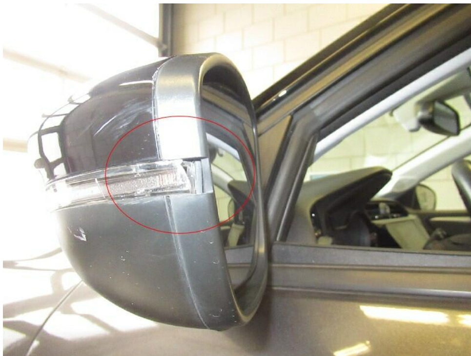
Bild 17 : Blinker l. gebrochen
