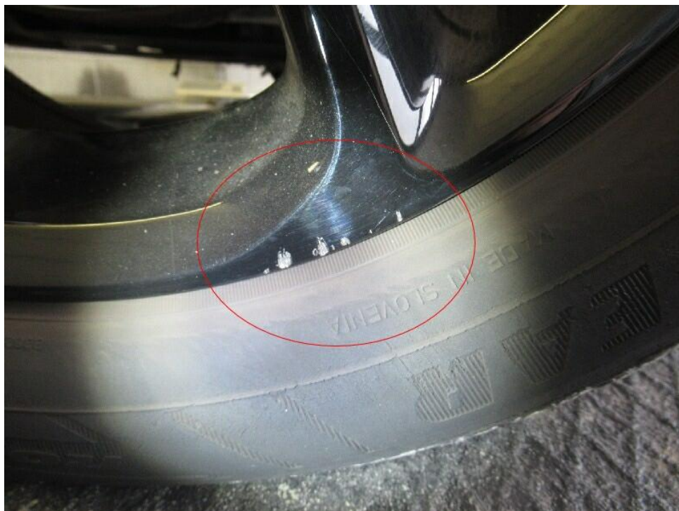
Bild 20 : Felge v.r. verschrammt
