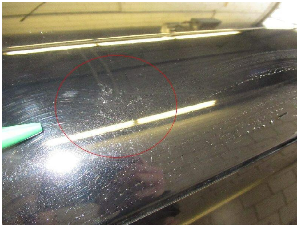
Bild 16 : Dachrahmen rechts Lackierung, Umweltschaden, lackieren mit Lackaufbau
