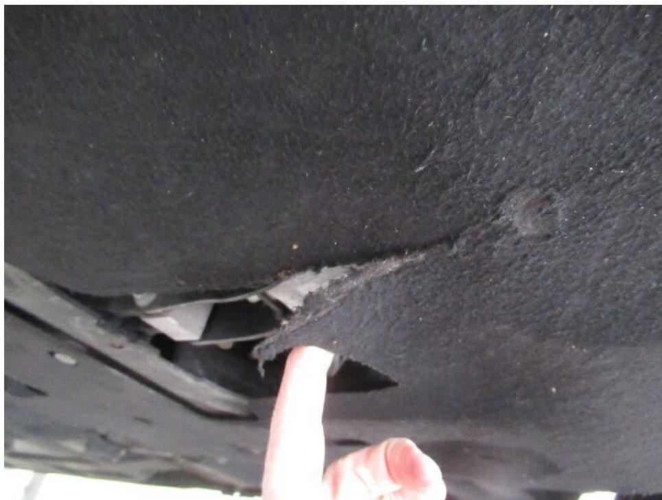
Bild 19 : Unterbodenverkleidung v. gebrochen
