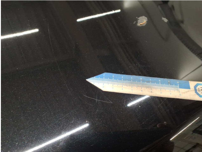
Damage 21: Bonnet: Bonnet (Verätzungen + Kratzer) - Paint defect - Repair and paint
