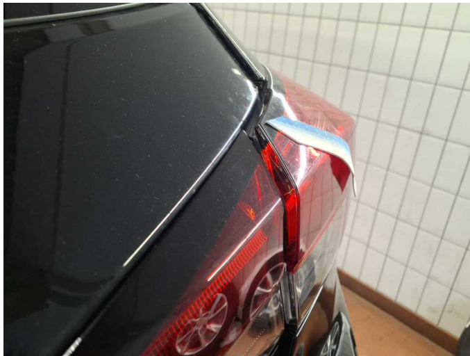
Damage 4: Boot lid / rear door: Boot lid (Spaltmaße) - Malposition - Set / adjust
