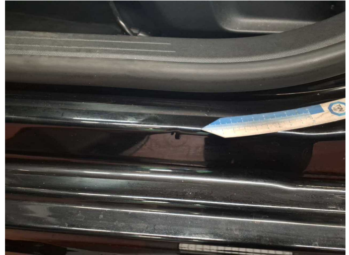
Damage 15: Sill - left side: Sill (erhöhter Aufwand; an Kante) - Dent / paintcoat damage - Smart repair
