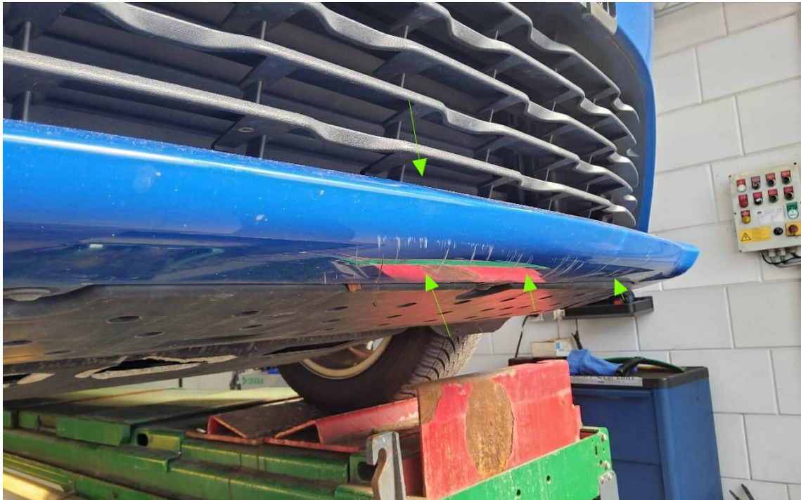
Bild 27 : Stoßfänger vorne angefahren
