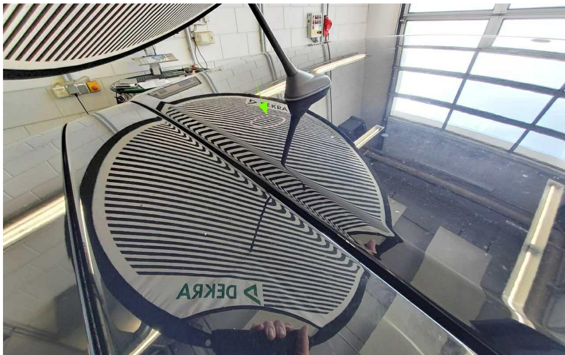
Bild 17 : Dach verdellt, verkratzt, Lackverätzungen
