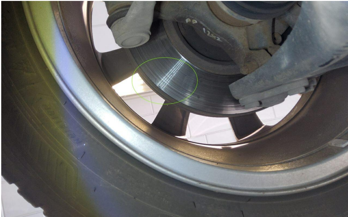
Bild 29 : T- Bremsscheiben Vorderachse innen eingelaufen
