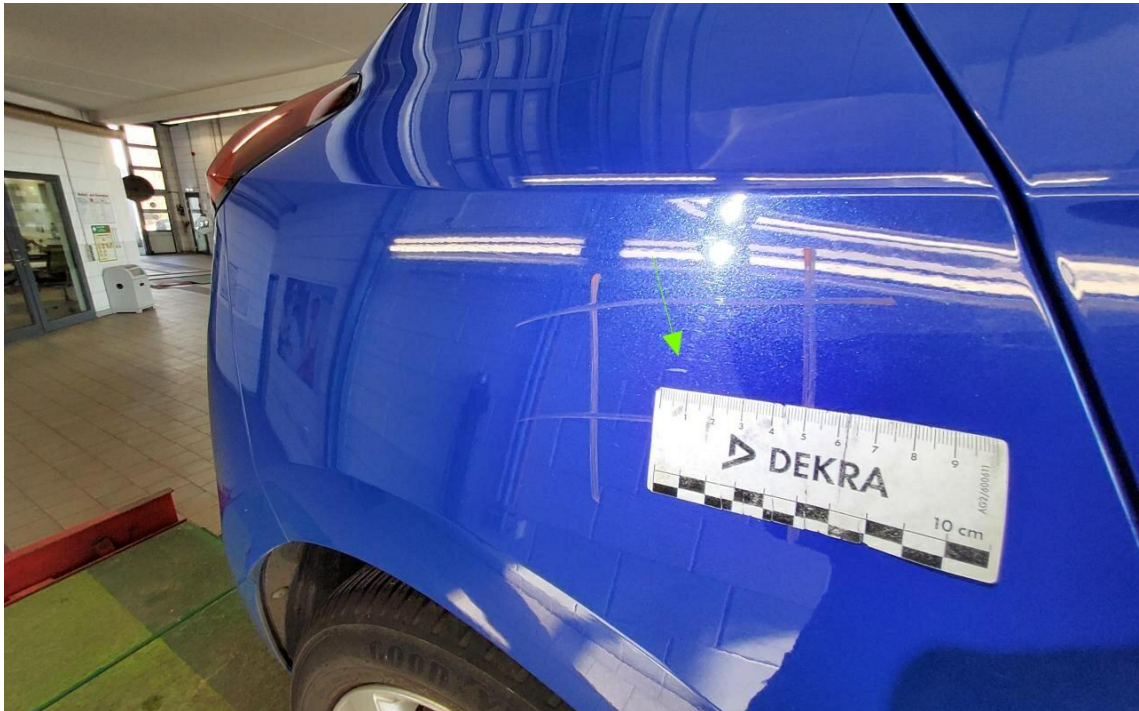
Bild 23 : Seitenteil rechts Kratzer, Delle
