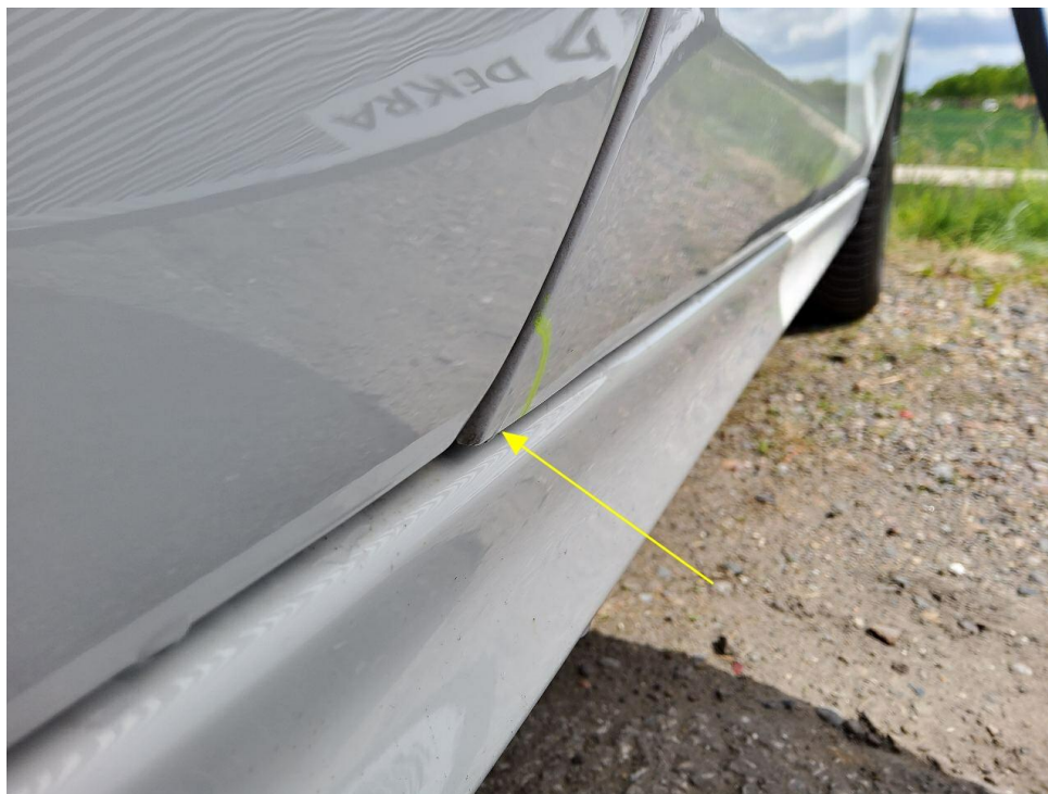
Bild 16 : Tür vorne rechts Bearbeitungsspuren sichtbar
