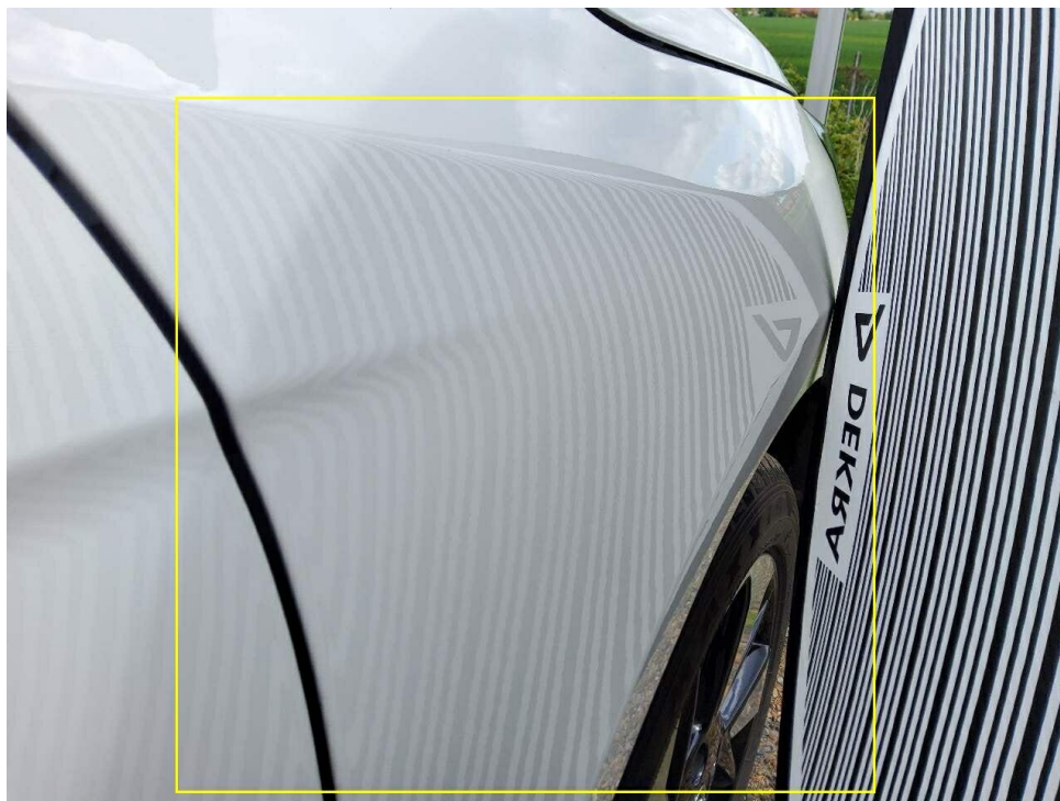
Bild 15 : Kotflügel vorne rechts Bearbeitungsspuren sichtbar
