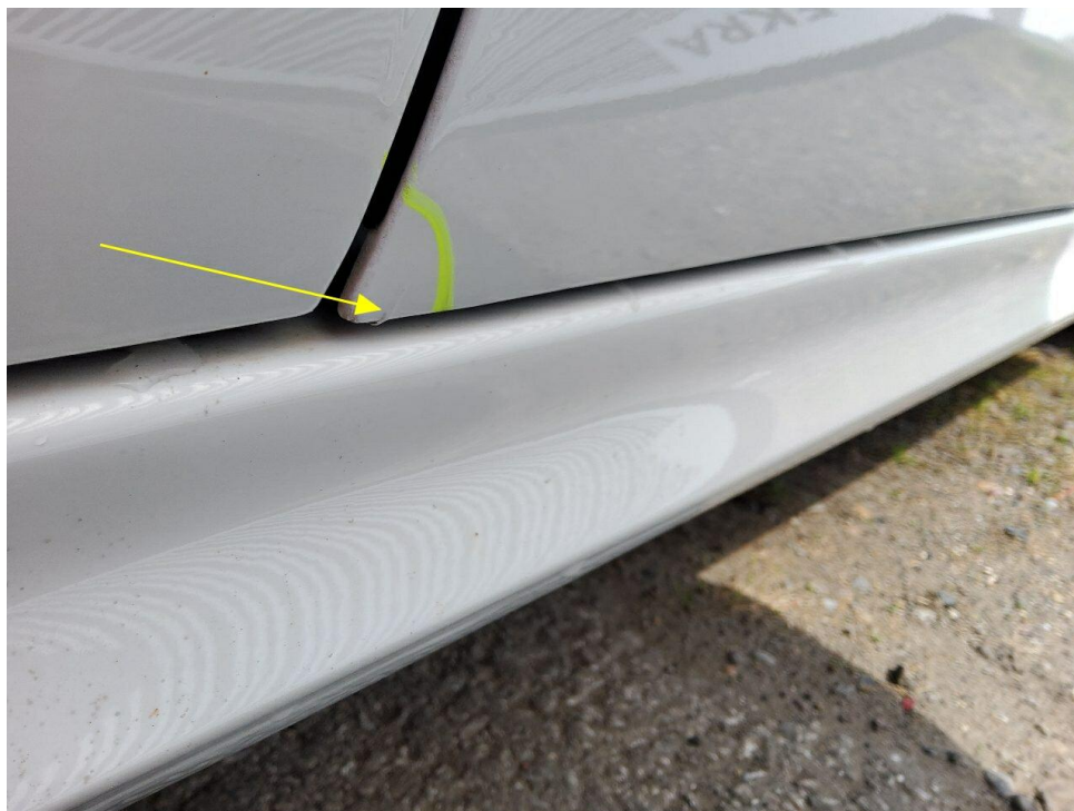
Bild 17 : Tür vorne rechts Bearbeitungsspuren sichtbar
