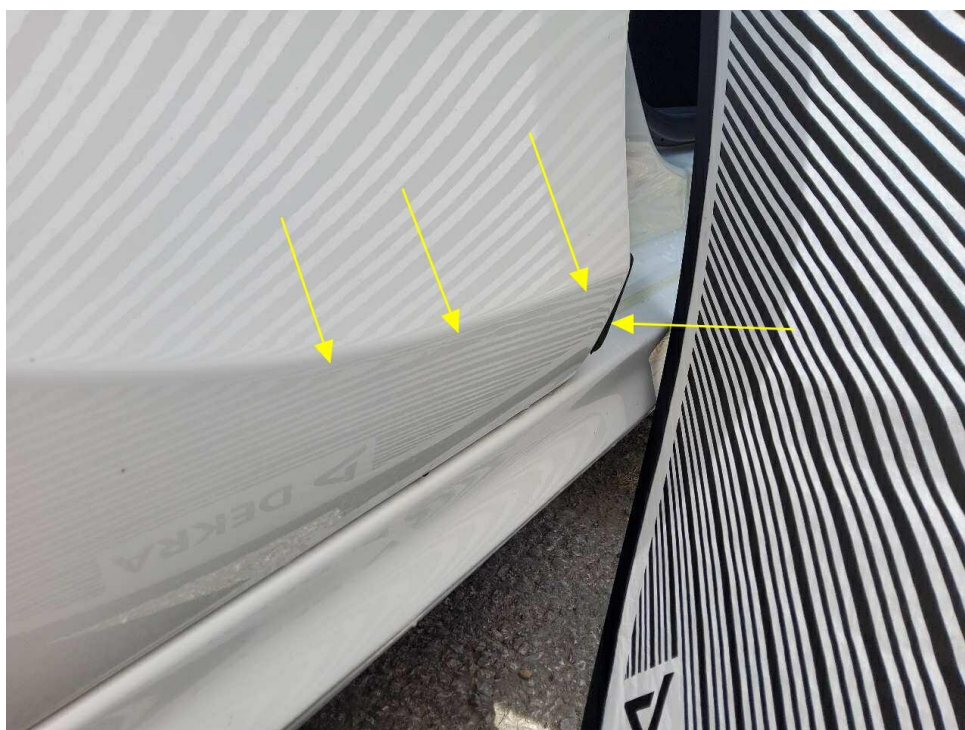
Bild 18 : Tür hinten rechts Bearbeitungsspuren sichtbar
