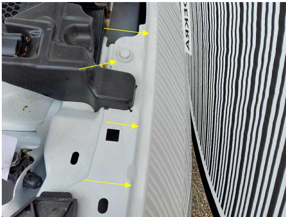
Bild 8 : Kotflügel vorne links Bearbeitungsspuren sichtbar
