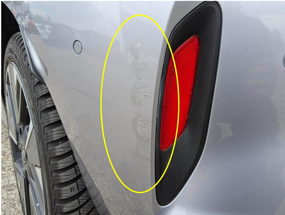
Bild 9 : Stoßfänger hinten Lackierung, verschrammt, lackieren mit Lackaufbau
