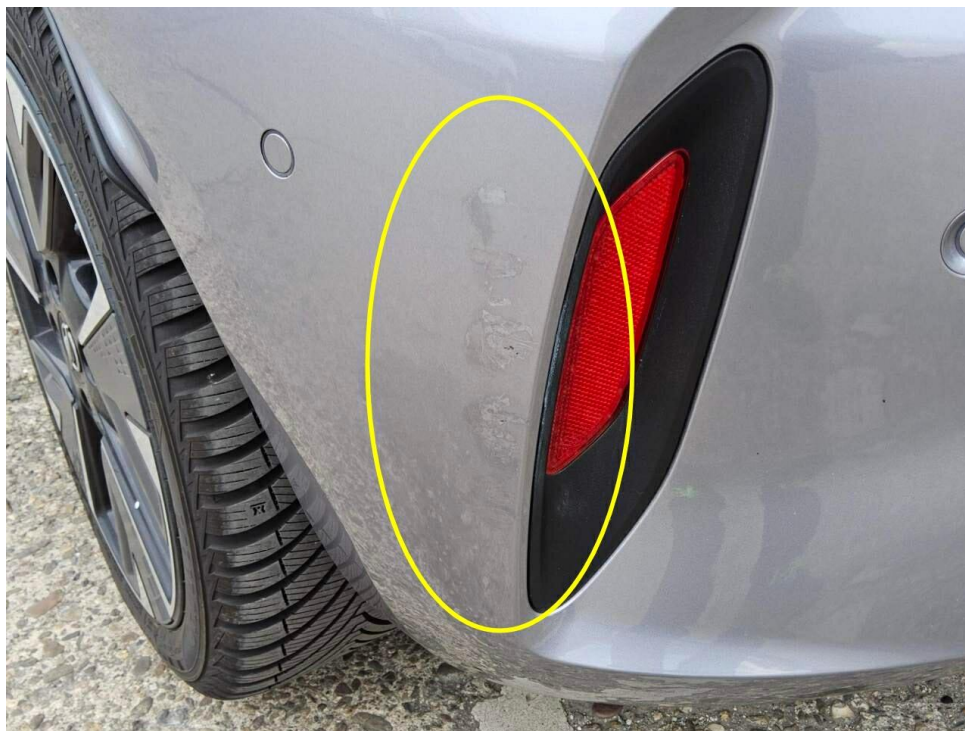
Bild 8 : Stoßfänger hinten Lackierung, verschrämmt, lackieren mit Lackaufbau
