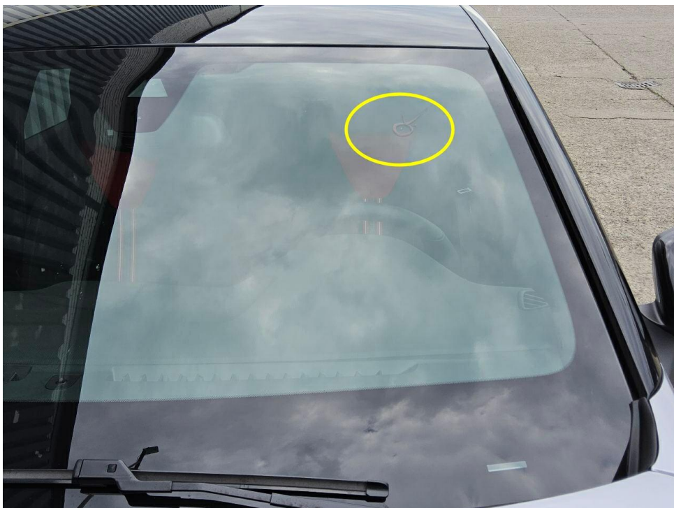
Bild 10 : Windschutzscheibe Steinschlag mit Rissbildung
