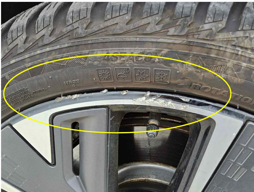
Bild 12 : Felge vorne rechts verschrammt (glanzgedreht)
