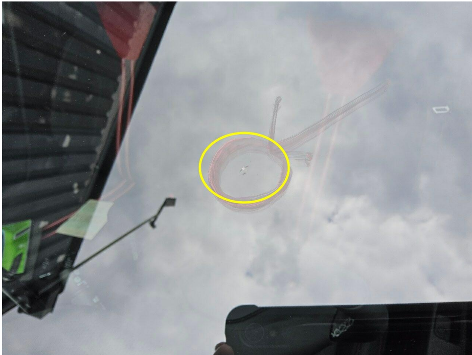
Bild 11 : Windschutzscheibe Steinschlag mit Rissbildung
