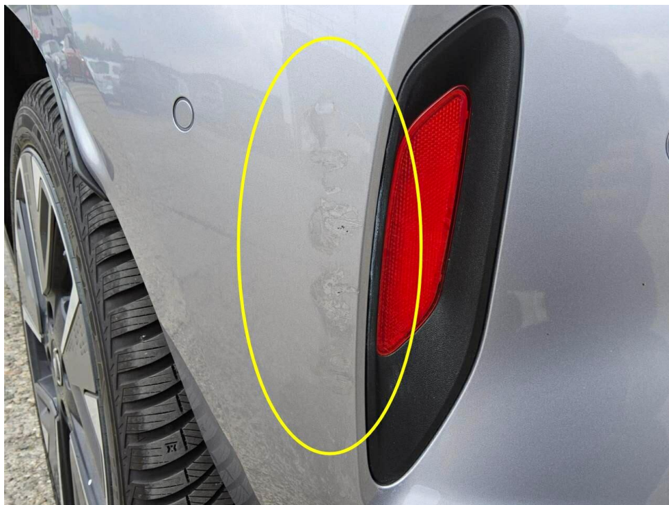
Bild 9 : Stoßfänger hinten Lackierung, verschrämmt, lackieren mit Lackaufbau
