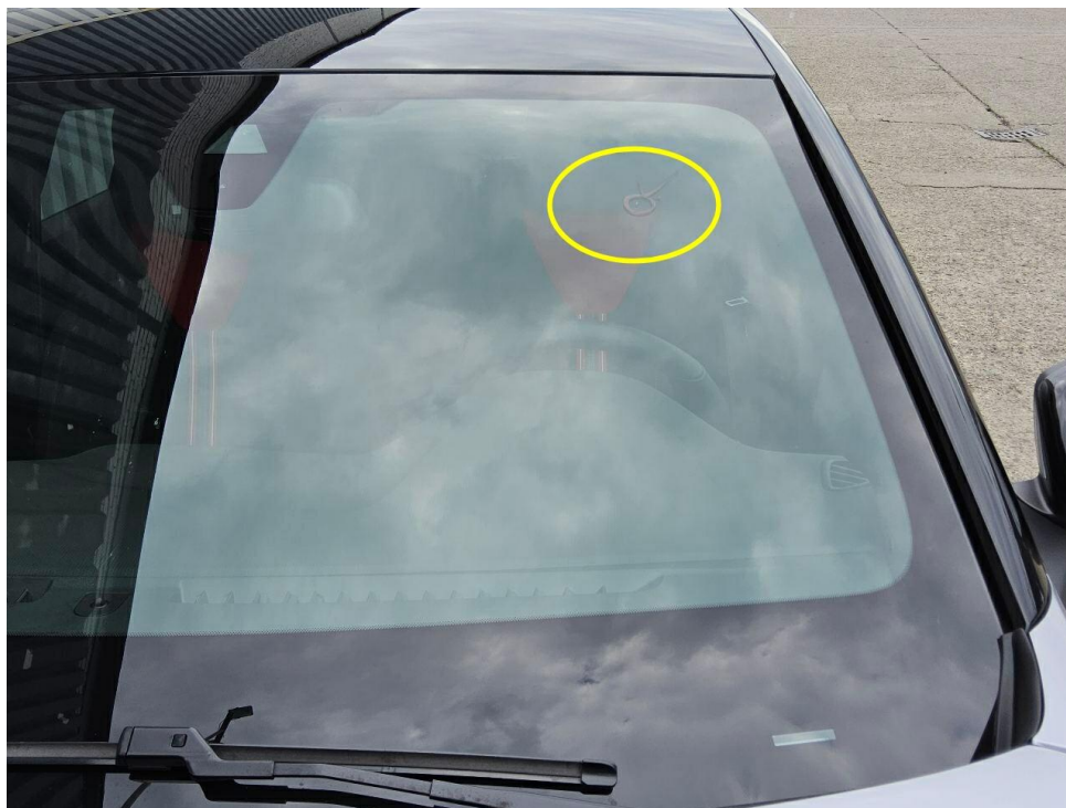
Bild 10 : Windschutzscheibe Steinschlag mit Rissbildung
