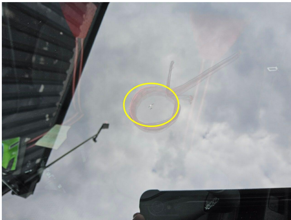
Bild 11 : Windschutzscheibe Steinschlag mit Rissbildung
