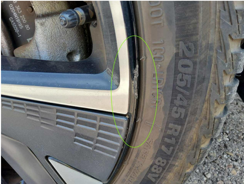
Bild 11 : LM-Felge vorn rechts Kratzer, Minderwert
