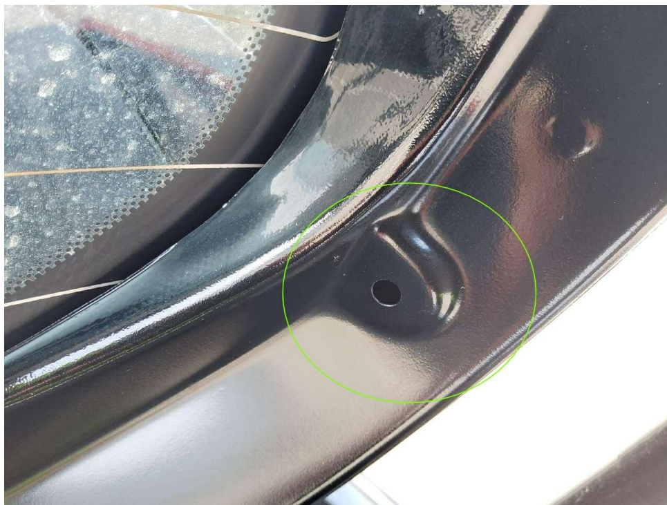
Bild 10 : Hutablage Halter fehlen
