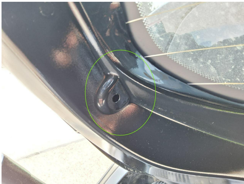
Bild 9 : Hutablage Halter fehlen
