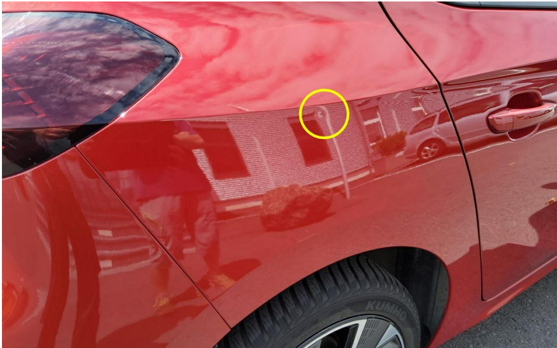
Bild 7 : Seitenteil hinten rechts, eingedellt, drücken
