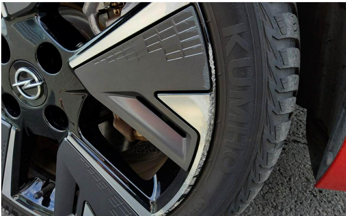
Bild 8 : Glanzgedrehte Felge vorne rechts, verkratzt mit Materialabrieb
