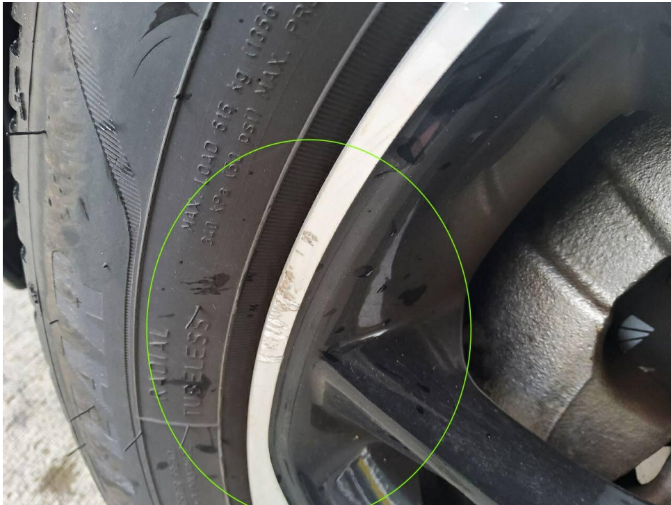
Bild 11 : LM-Felge vorn links Kratzer, Minderwert
