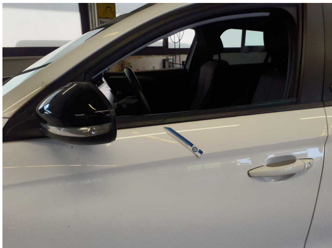
Beschädigung 3: Tür vorn links: Schachtleiste außen - Kratzer - erneuern
