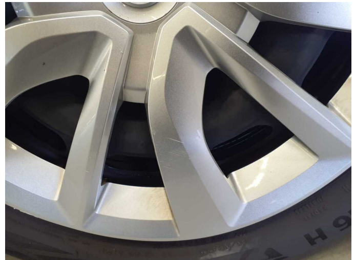
Beschädigung 1: Rad/Reifen: Radblende hinten links (+verformt) - Kratzer - erneuern
