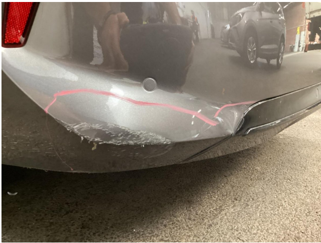
Stoßfänger hinten - stark deformiert - erneuern
