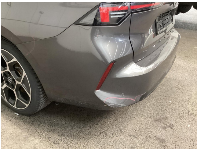
Stoßfänger hinten - stark deformiert - erneuern
