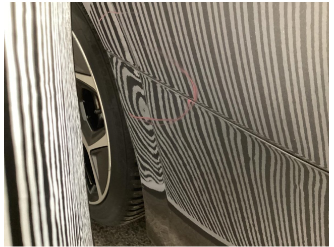
Stoßfänger hinten - stark deformiert - erneuern
