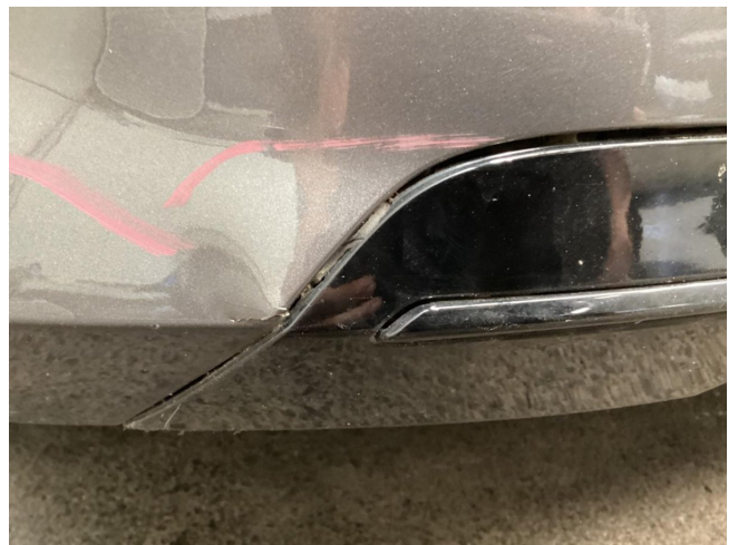
Stoßfänger hinten - stark deformiert - erneuern
