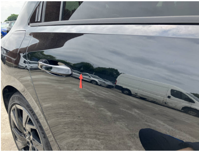
Tür hinten rechts - leicht deformiert - instandsetzen und lackieren
