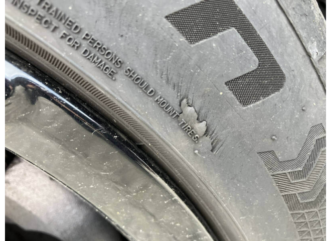
Reifen (Ganzjahres-Radsatz) - Vorderachse rechts - Reifen Vo re verschlissen - erneuern
