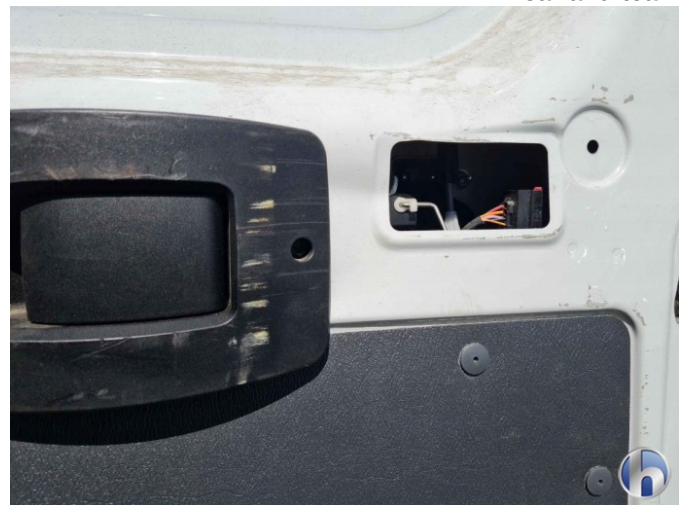
6. Hecktürverkleidung rechts Damaged
