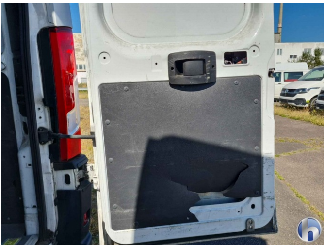
6. Hecktürverkleidung rechts Damaged
