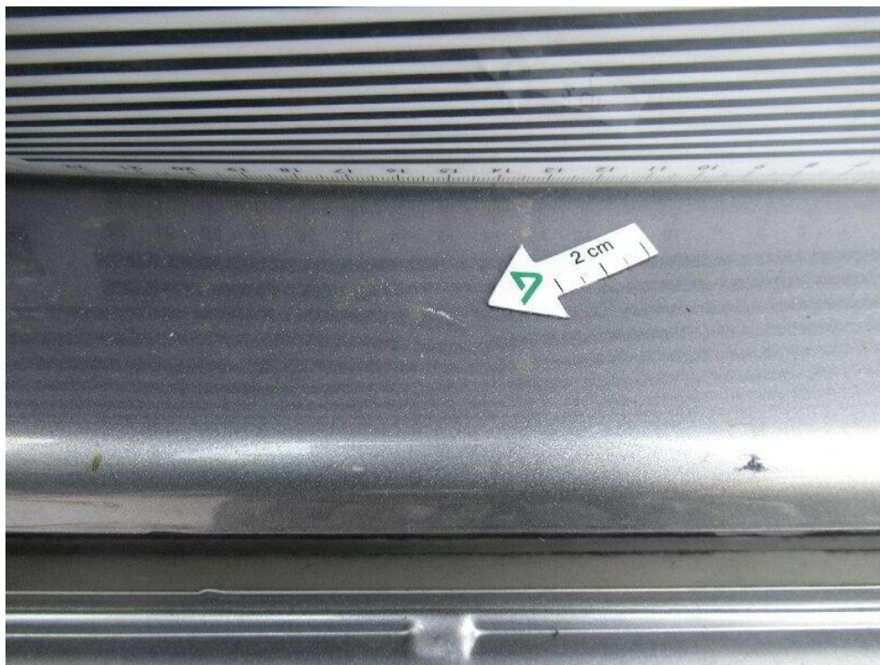
Bild 29 : Einstieg hinten rechts Delle
