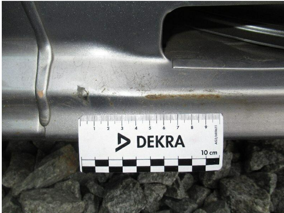
Bild 25 : Einstieg Schiebetür links Lackschaden
