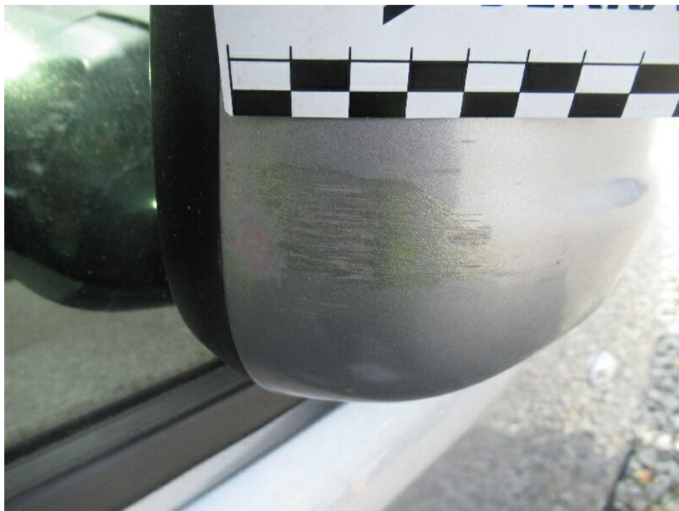
Bild 30 : Spiegelkappe rechts verschrammt
