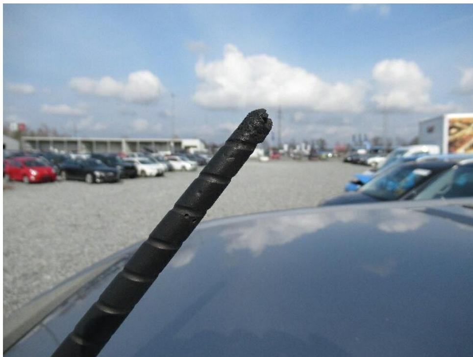
Bild 17 : Antenne beschädigt (Tierbisse)
