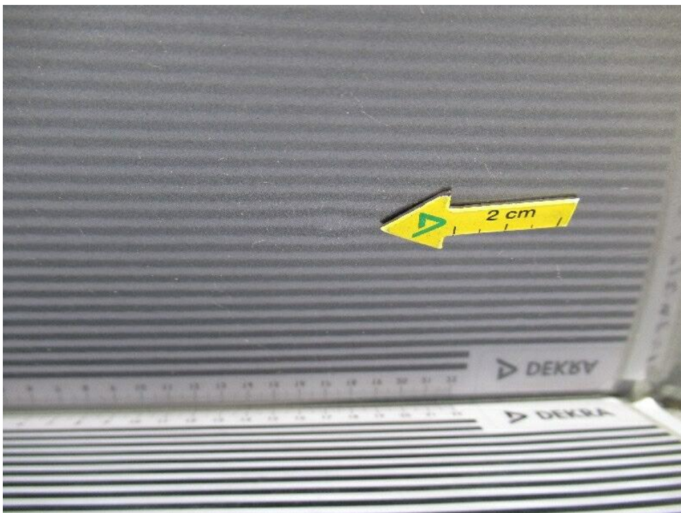
Bild 20 : Delle Schiebetür links
