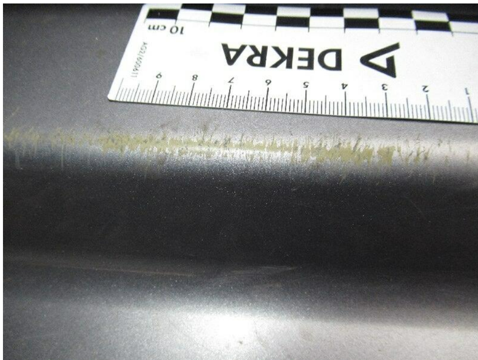
Bild 24 : Einstieg vorne links Lackschaden
