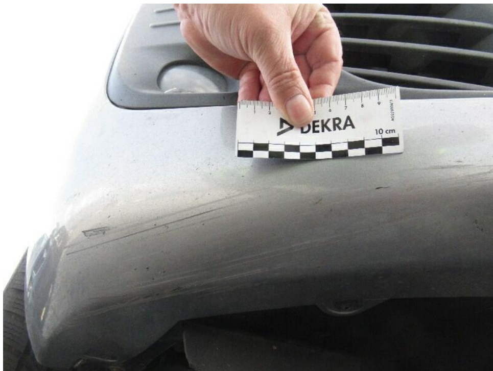
Bild 18 : Stoßfänger vorne rechts unten verschrammt
