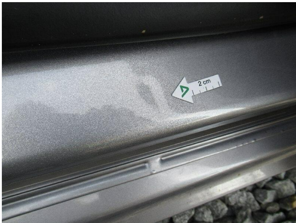
Bild 23 : 2x Delle Einstieg hinten links
