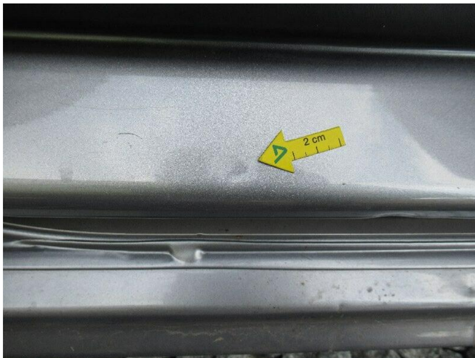
Bild 22 : 2x Delle Einstieg hinten links
