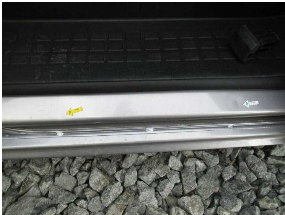
Bild 21 : 2x Delle Einstieg hinten links
