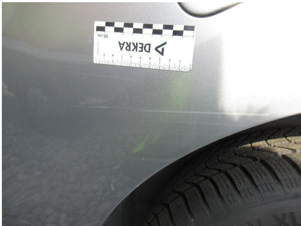
Bild 26 : Seitenteil links zerkratzt
