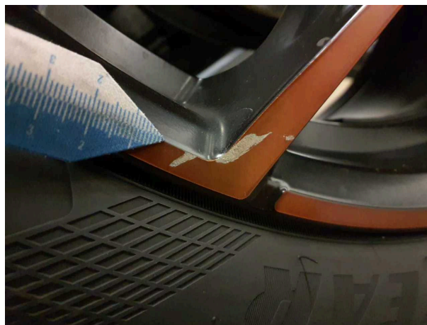
Beschädigung 4: Rad/Reifen: Leichtmetallfelge vorn rechts - verkratzt / verschürft - Smart Repair
