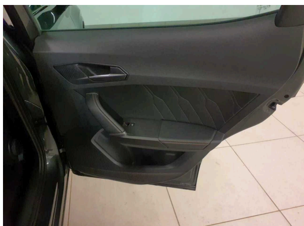
Beschädigung 3: Verkleidungen/Abdeckungen: Türverkleidung hinten rechts (Griff) - verkratzt / verschürft - Smart Repair
