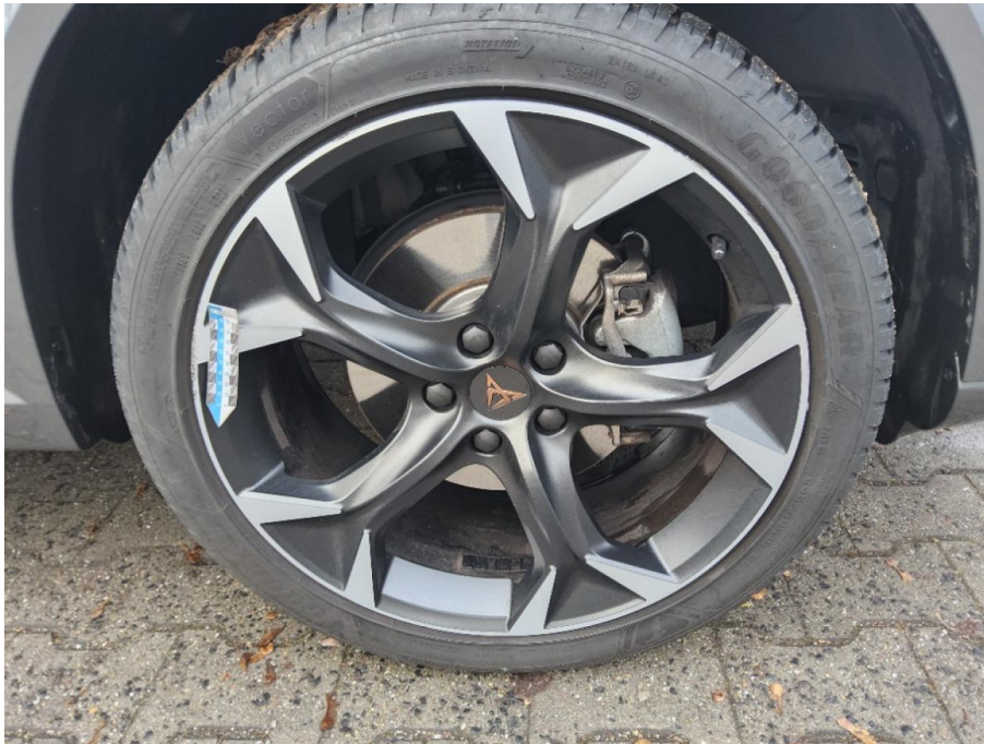
Bild 11 Alufelge vorne rechts Verschrammt - Erneuern
