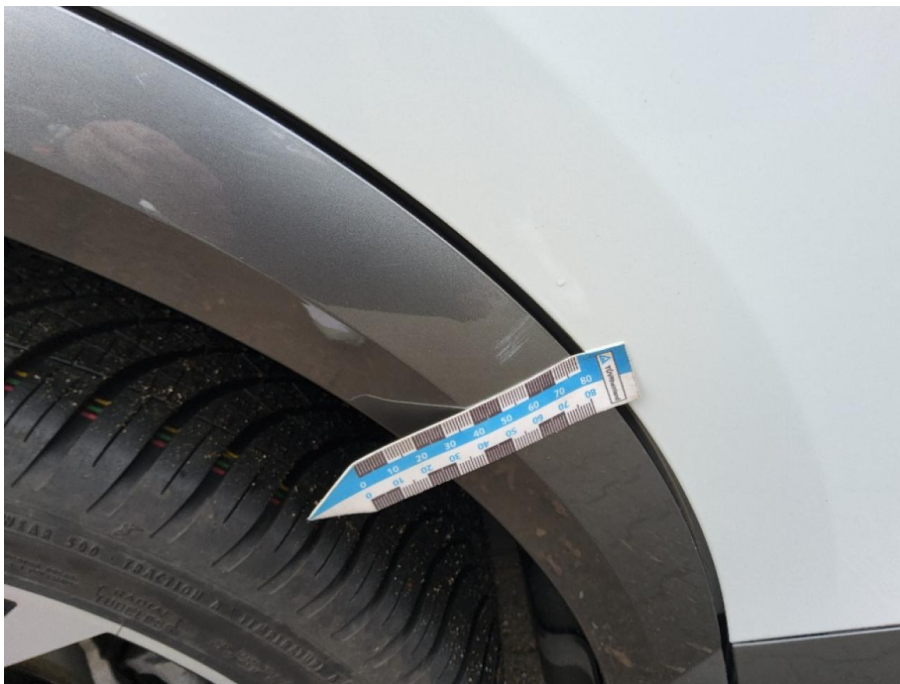
Bild 10 Radhausverbreiterung hinten rechts Verschrammt - Smart repair
