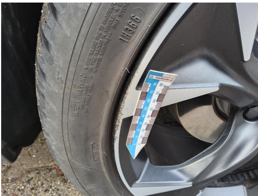
Bild 12 Alufelge vorne rechts Verschrammt - Erneuern
