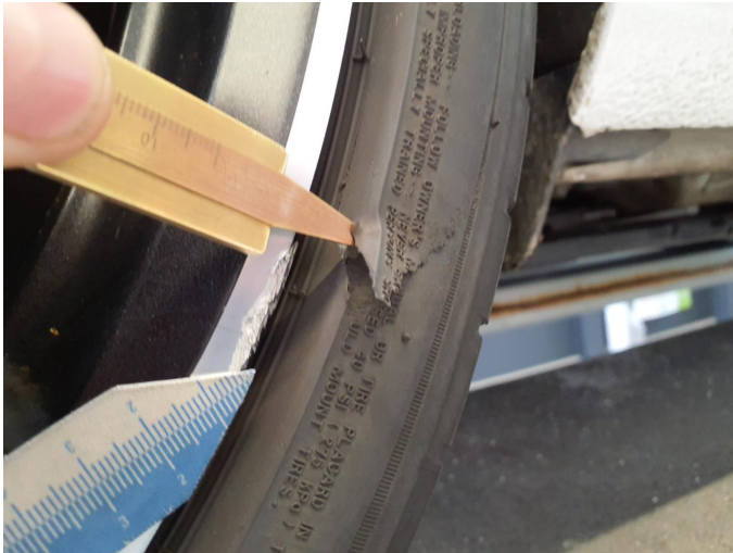
Beschädigung 2: Rad/Reifen: Reifen hinten rechts - beschädigt - erneuern
