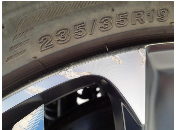
Beschädigung 3: Rad/Reifen: Leichtmetallfelge hinten rechts (starker Abrieb, Glanzgedrehte Oberfläche) - verkratzt / verschürft - erneuern
