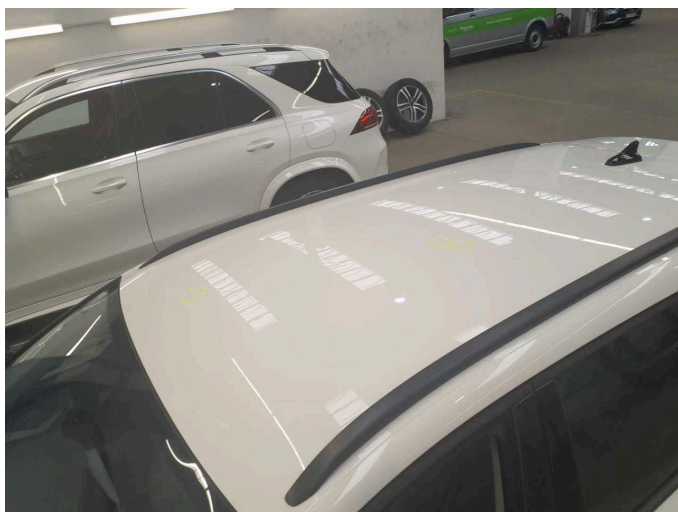
Beschädigung 2: Fahrzeugdach: Dach - Delle(n) - Smart Repair
