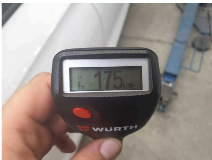
Nachlackierung 1: Dachholm rechts, Kotflügel rechts, Seitenwand rechts, Tür vorne rechts
