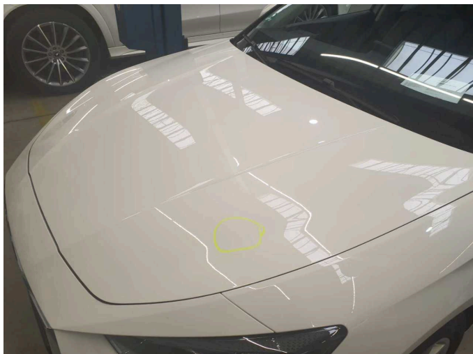
Beschädigung 1: Motorhaube: Motorhaube - Delle(n) - Smart Repair
