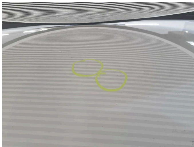
Beschädigung 2: Fahrzeugdach: Dach - Delle(n) - Smart Repair
