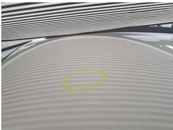
Beschädigung 2: Fahrzeugdach: Dach - Delle(n) - Smart Repair
