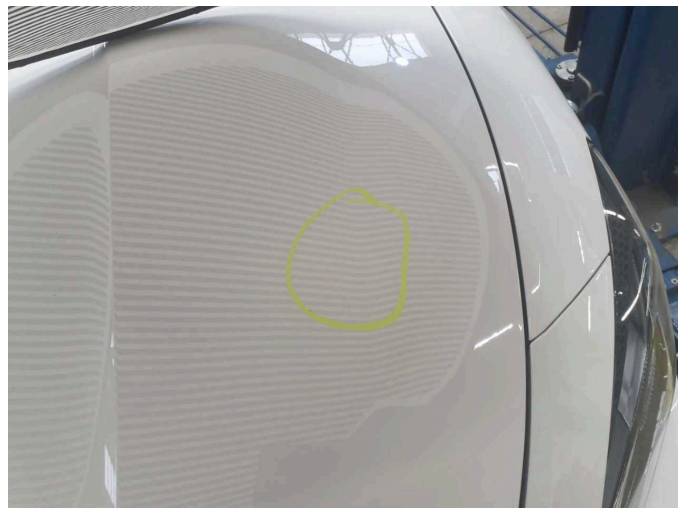
Beschädigung 1: Motorhaube: Motorhaube - Delle(n) - Smart Repair
