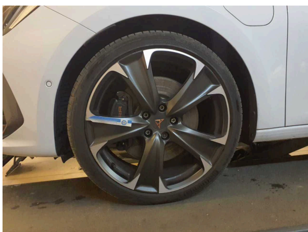
Beschädigung 5: Rad/Reifen: Leichtmetallfelge vorn links - verkratzt / verschürft - Smart Repair
