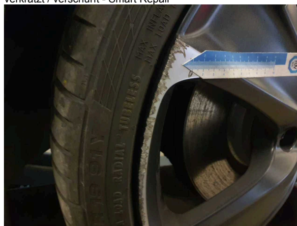
Beschädigung 6: Rad/Reifen: Leichtmetallfelge vorn rechts - verkratzt / verschürft - Smart Repair
