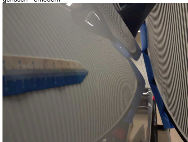
Beschädigung 9: Tür vorn rechts: Tür - verformt - instandsetzen und lackieren
