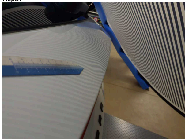
Beschädigung 3: Heckklappe/-tür: Heckklappe - Delle(n) - Smart Repair
