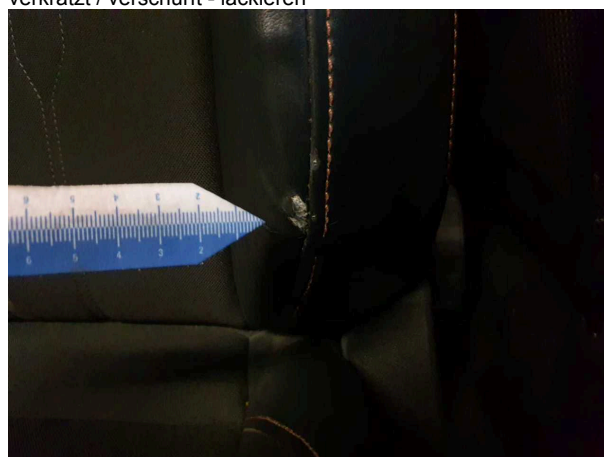
Beschädigung 8: Sitz vorn: Lehnenbezug links - gebrochen / gerissen - erneuern
