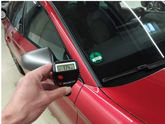
Dachholm rechts: 174 \mu\text{m}
