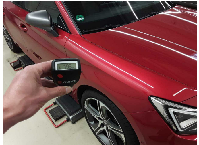
Kotflügel rechts: 196 \mu\text{m}
