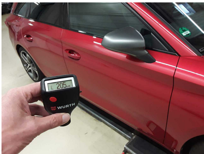
Door - front right side: 205 µm
