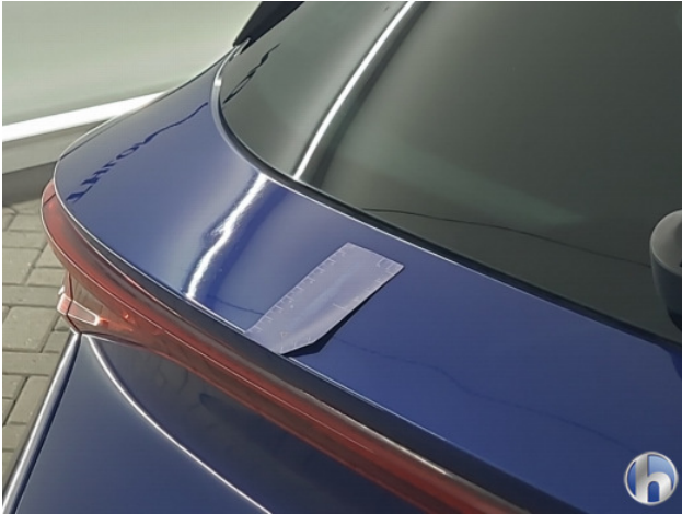
1. Achterklep Deuk/deuken - Aanvaardbaar
