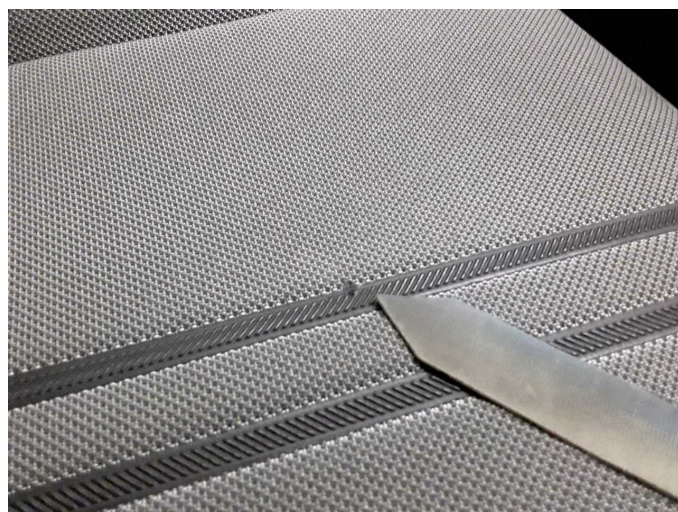
Beschädigung 9: Sitz vorn: Sitzbezug links - Brandloch - erneuern
