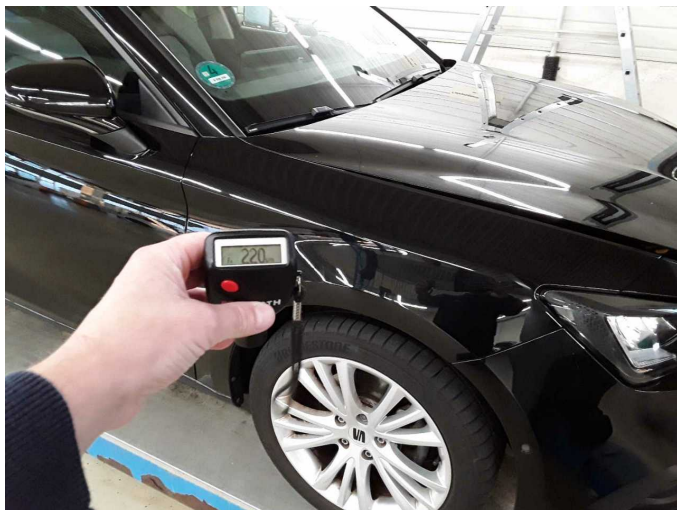
Kotflügel rechts: 220 µm
