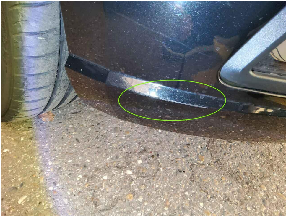
Bild 30 : Stoßfänger vorne rechts verschrammt
