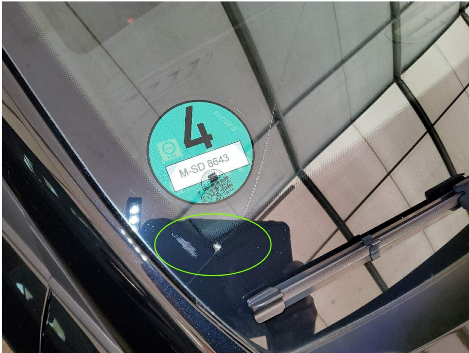
Bild 25 : Frontscheibe Steinschlag mit Rissbildung
