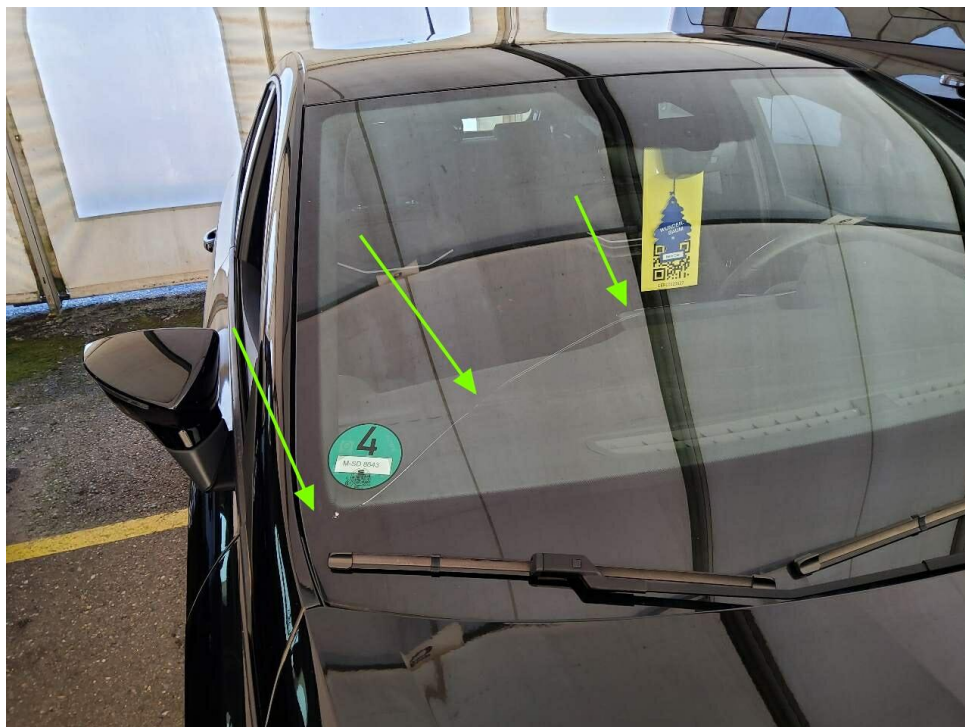
Bild 24 : Frontscheibe Steinschlag mit Rissbildung
