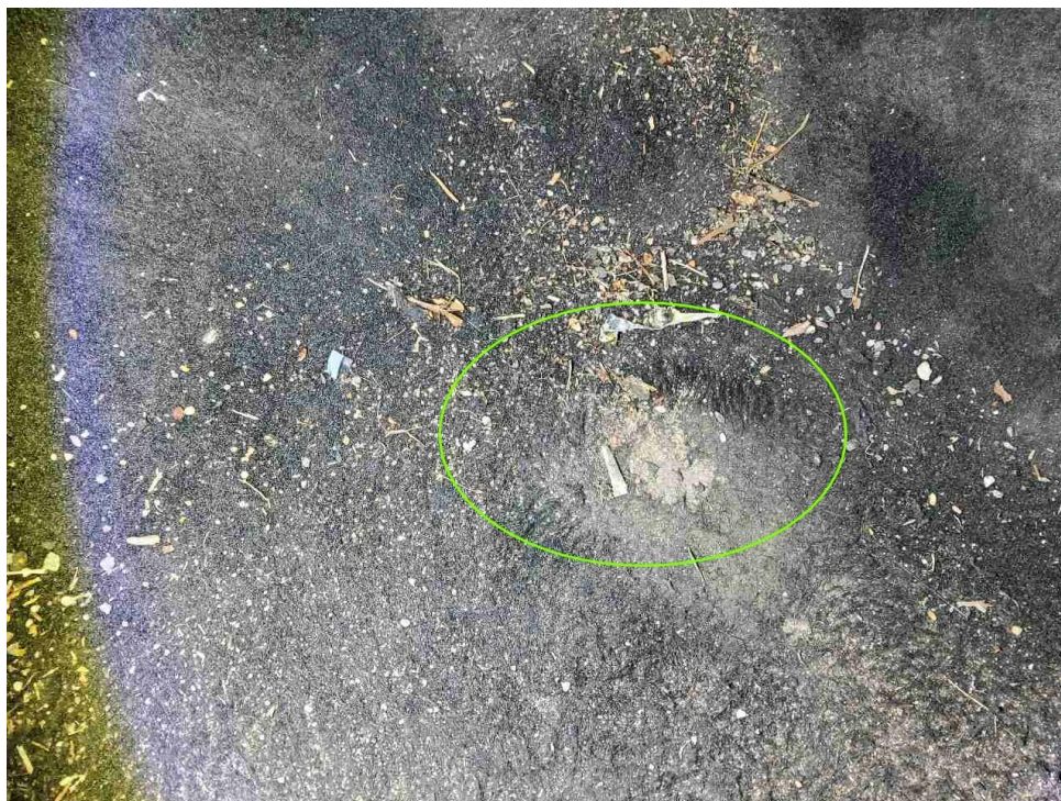
Bild 19 : Teppichboden Bereich Fahrerfußraum beschädigt
