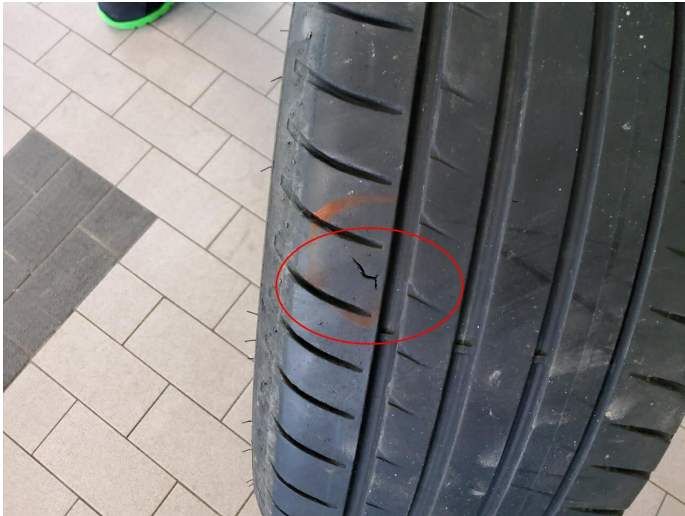
Bild 19 : Sommerreifen vorn links, Einschnitt in der Lauffläche
