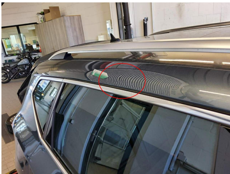
Bild 16 : Dachrahmen rechts, mehrfach eingedellt, drücken
