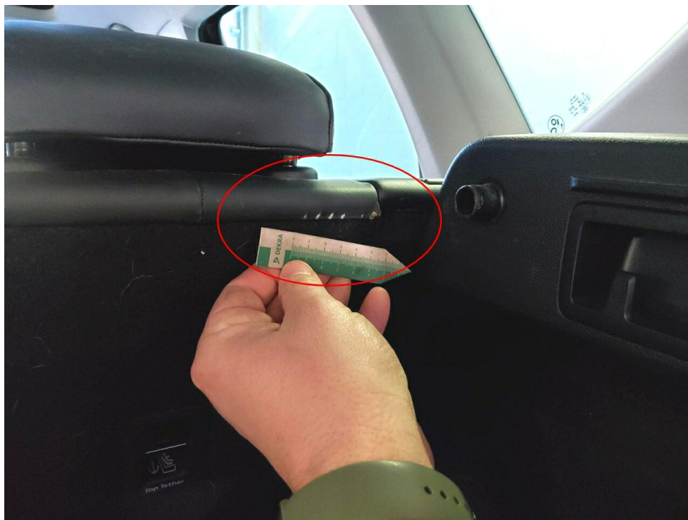
Bild 17 : Sitz 1. Reihe rechts Sitzlehnenbezug, gerissen, smart repair
