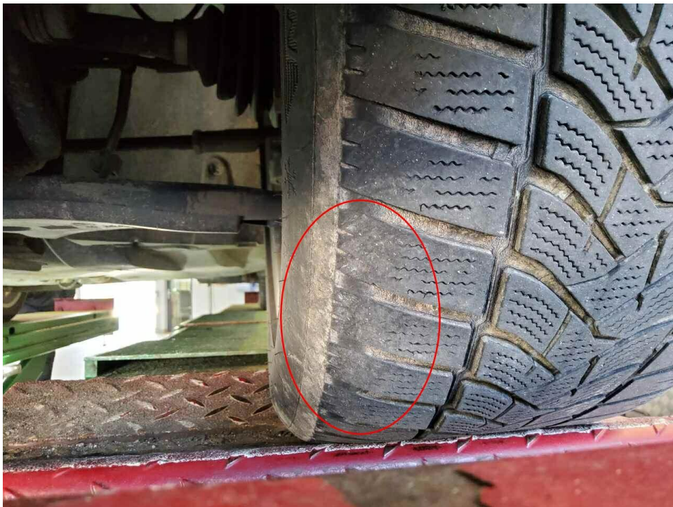
Bild 20 : Winterreifen vorn links, einseitig abgefahren
