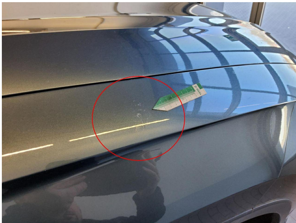
Bild 22 : Kotflügel vorne rechts Lackierung oberhalb, Umweltschaden, polieren
