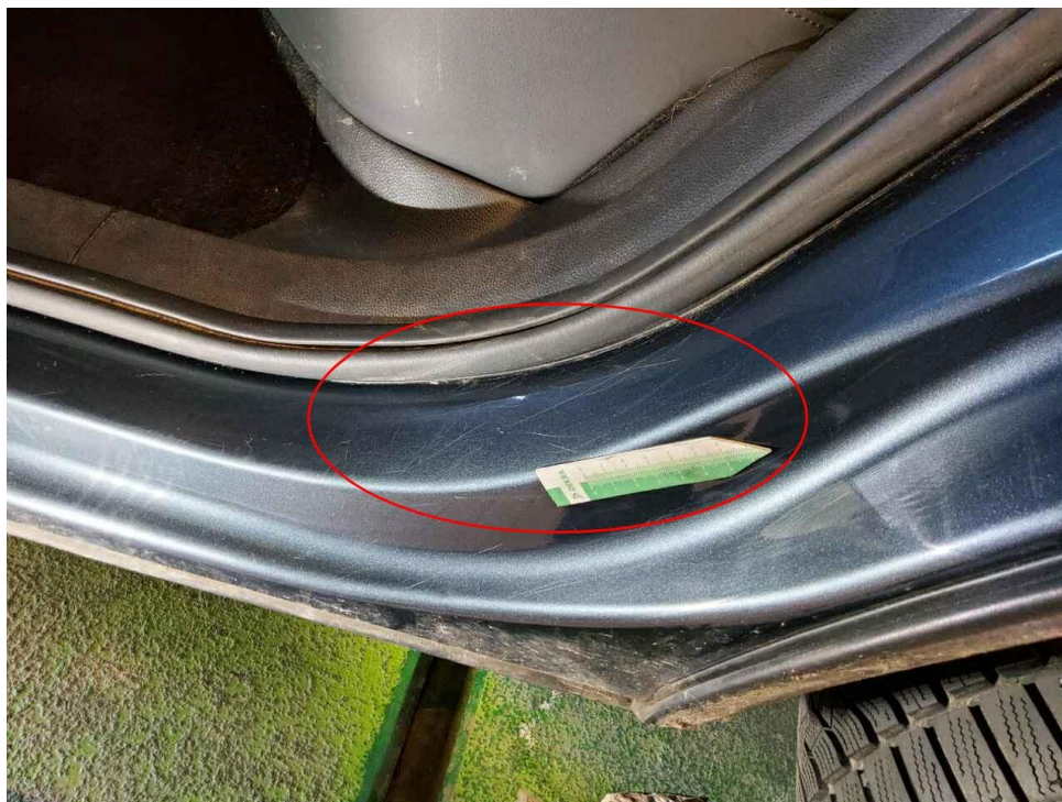
Bild 27 : Tür hinten links Einstieg Lackierung, zerkratzt, polieren
