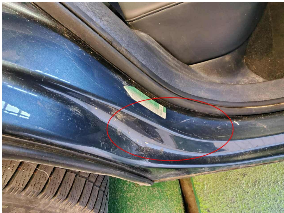
Bild 24 : Tür hinten rechts Einstieg Lackierung, zerkratzt, polieren
