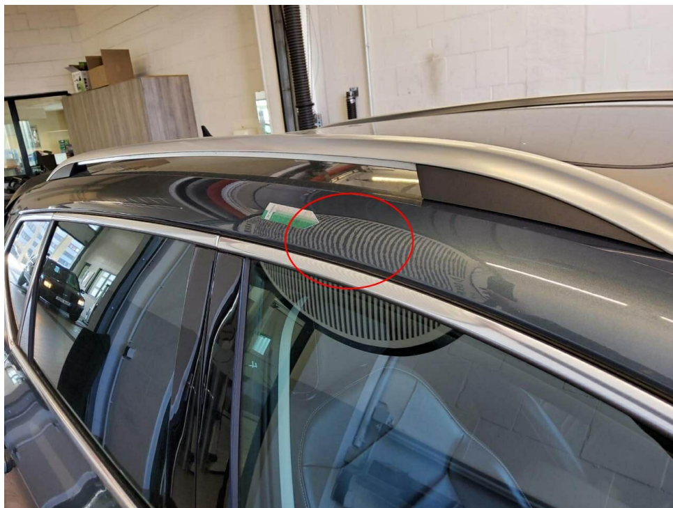
Bild 15 : Dachrahmen rechts, mehrfach eingedellt, drücken
