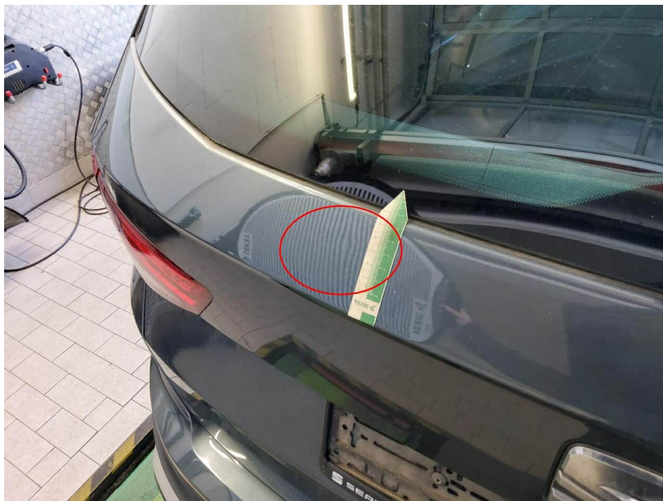
Bild 31 : Heckklappe, eingedellt, drücken
