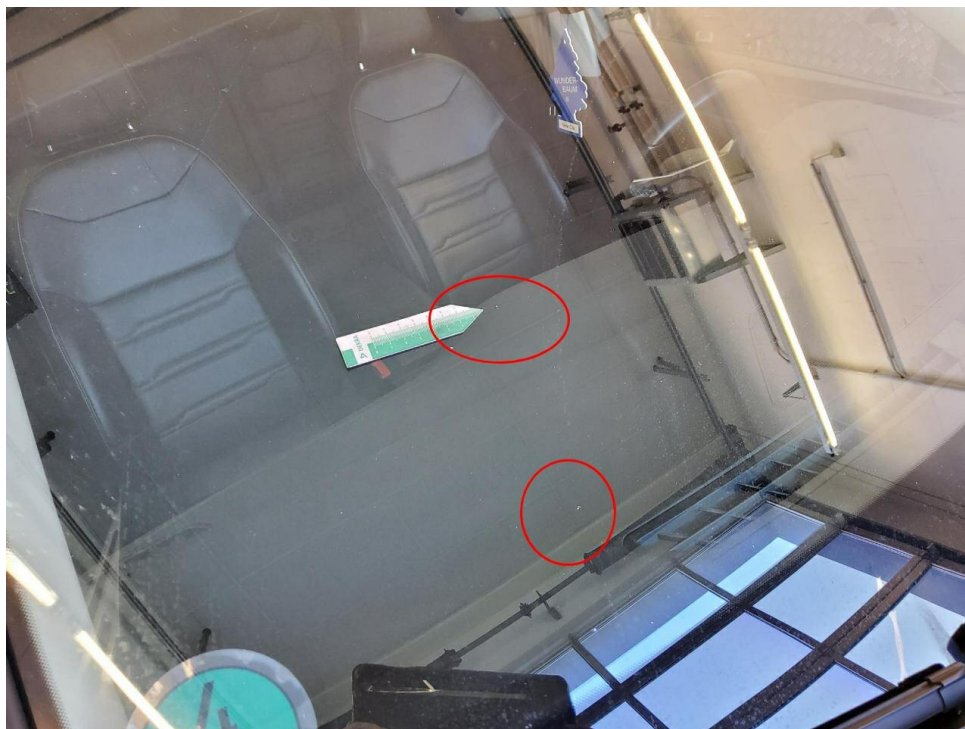
Bild 21 : Frontscheibe, Steinschlag, Gebrauchsspur
