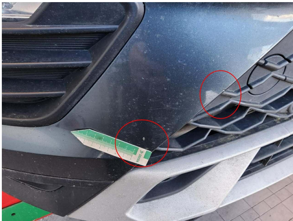
Bild 30 : Stoßfänger vorne Lackierung, Steinschlag, Gebrauchsspur
