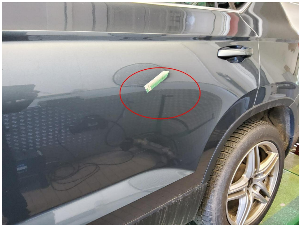
Bild 28 : Tür hinten links Lackierung, verschrammt, polieren
