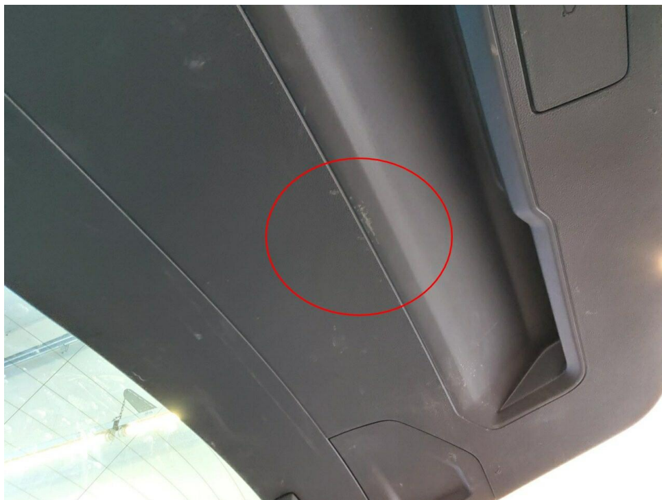
Bild 25 : Verkleidung Heckklappe, verschrammt, Gebrauchsspur
