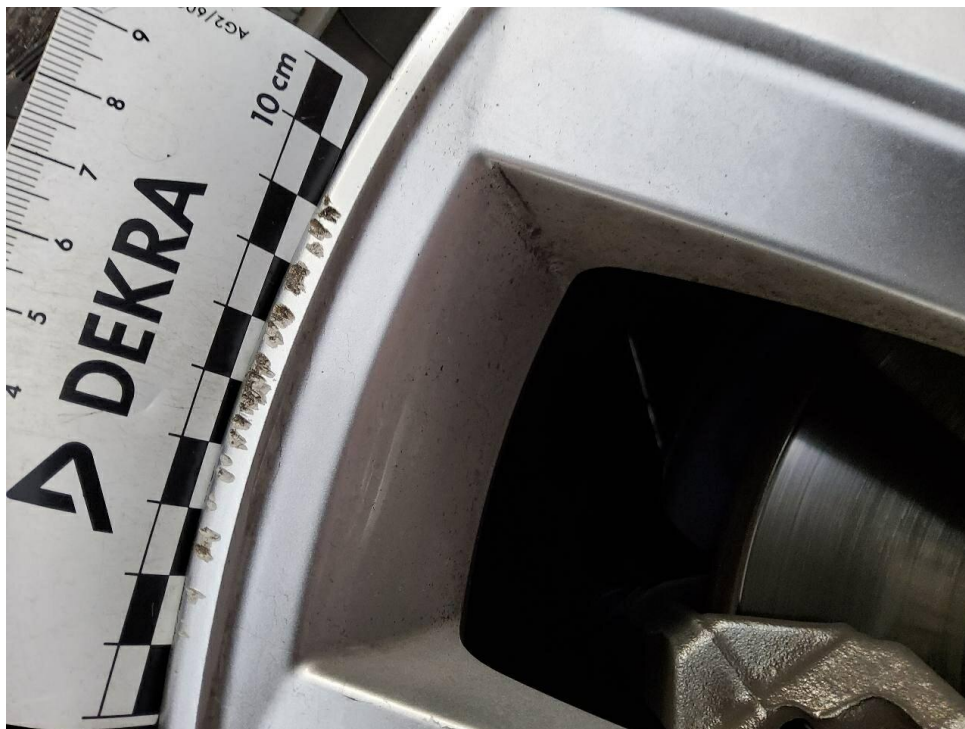
Bild 15 : Felge vorne links, verschrammt, smart repair
