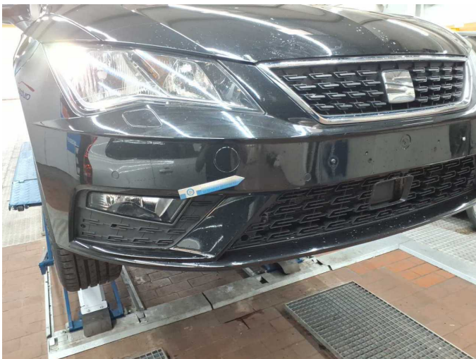
Damage 1: Front bumper: Front bumper (Übermäßige Steinschläge) - Stone chips - Paint
