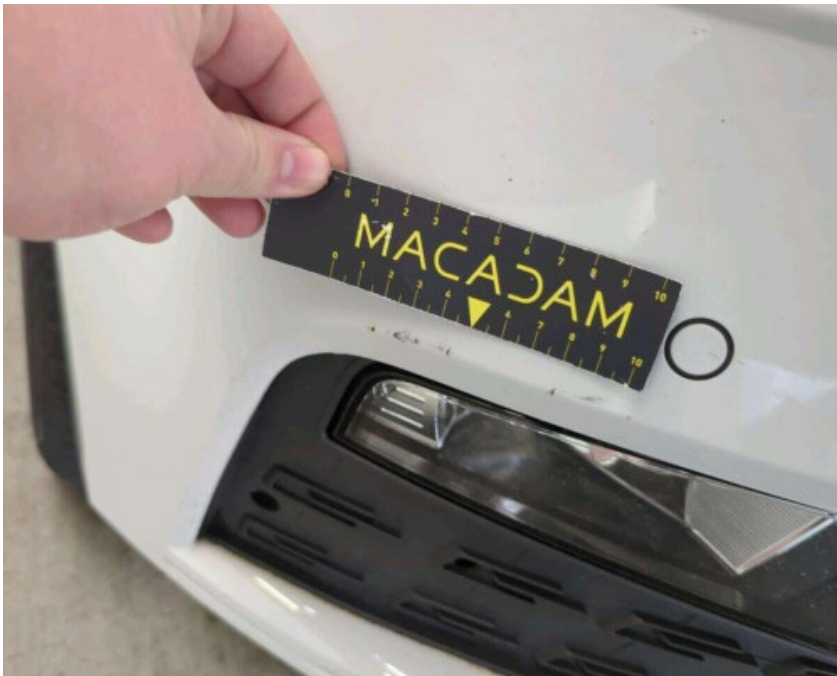
Bumper V: Kras(sen) Repair method: Herstellen en spuiten (compleet)
