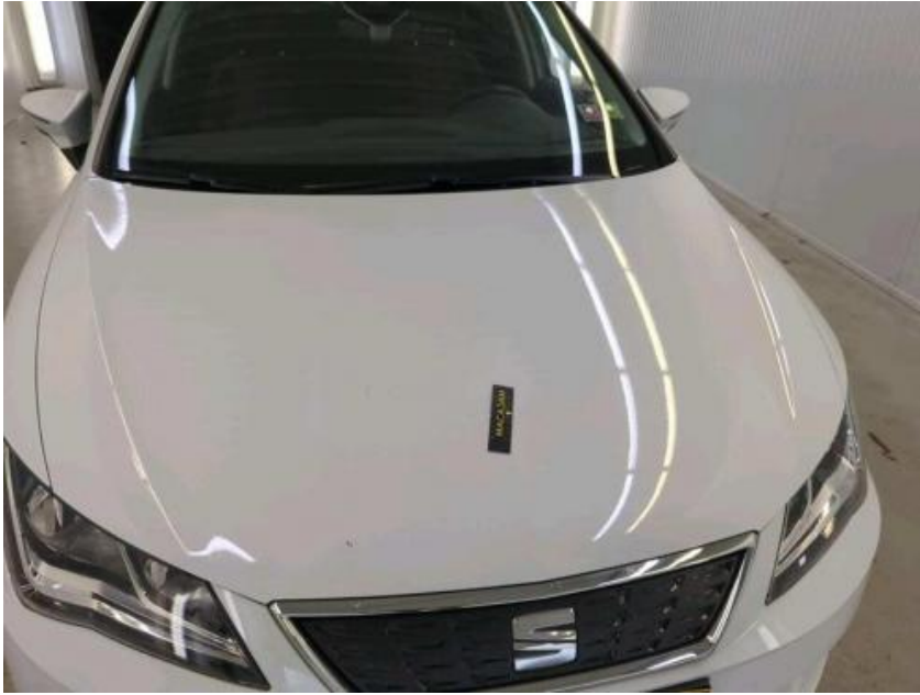
Motorkap: Chemische schade Repair method: polijsten
