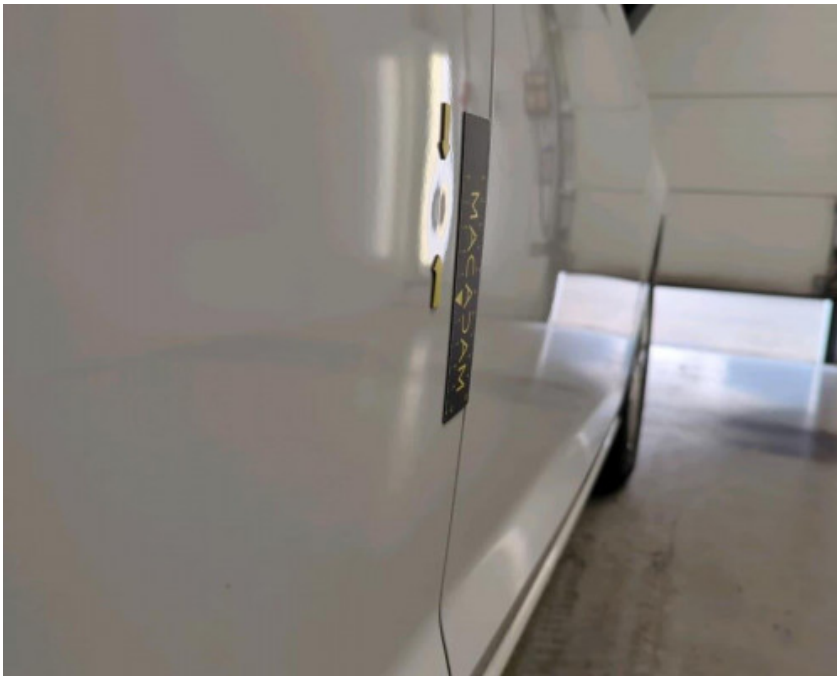
Deur A R: Deuk(en) Repair method: Uitdeuken zonder spuiten
