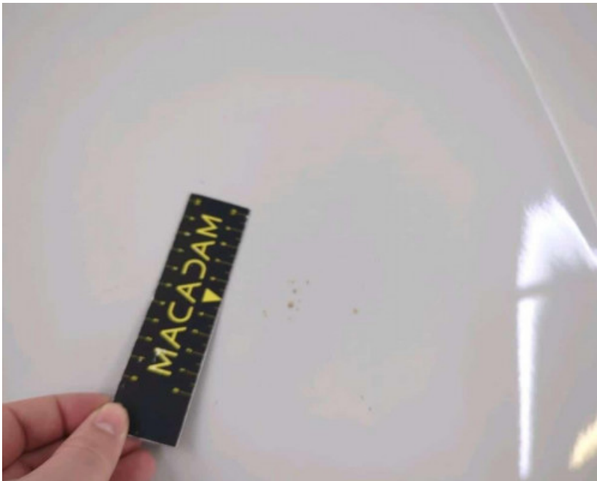
Motorkap: Chemische schade Repair method: polijsten
