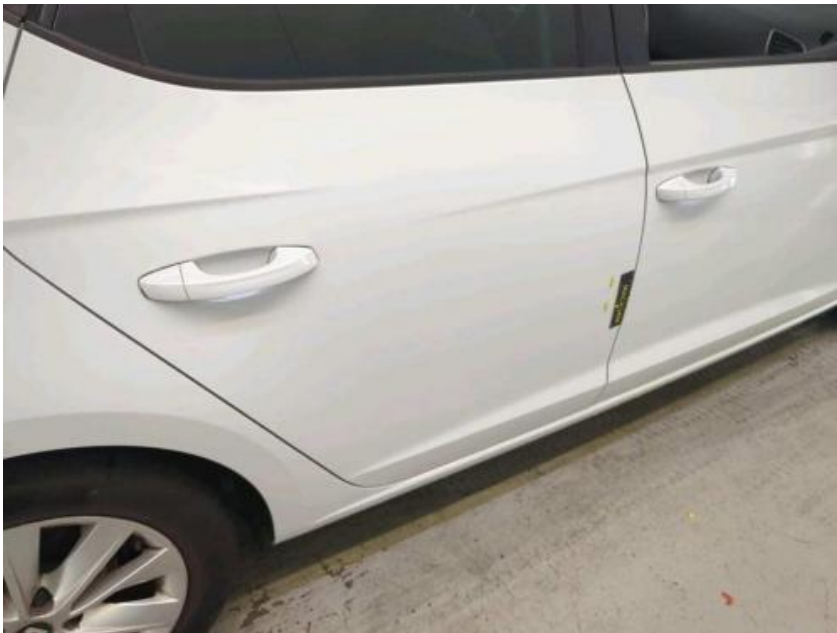
Deur A R: Deuk(en) Repair method: Uitdeuken zonder spuiten
