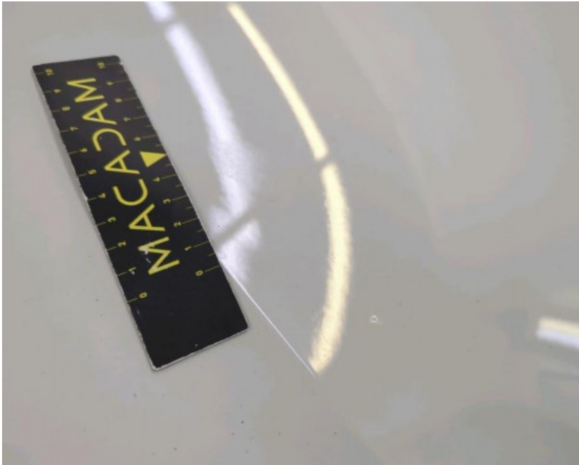
Motorkap: Chemische schade Repair method: polijsten
