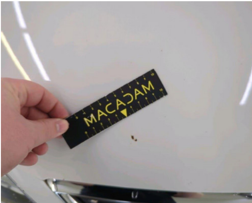
Motorkap: Chemische schade Repair method: polijsten
