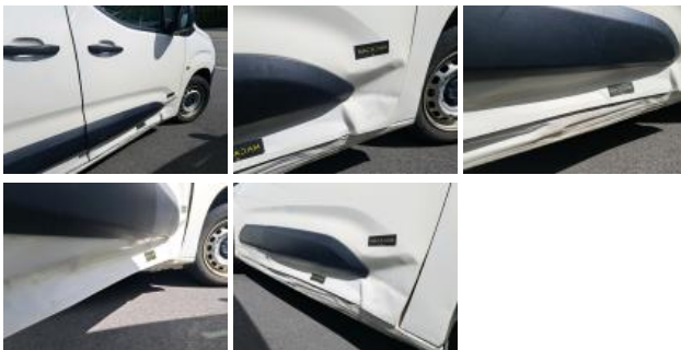
Door trim FR, Scratch(es), Replace
