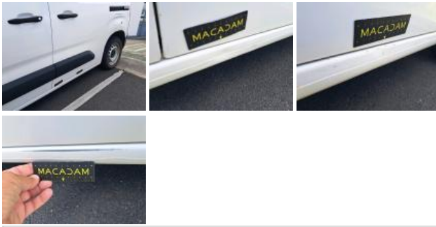
Door trim FL, Scratch(es), Replace
