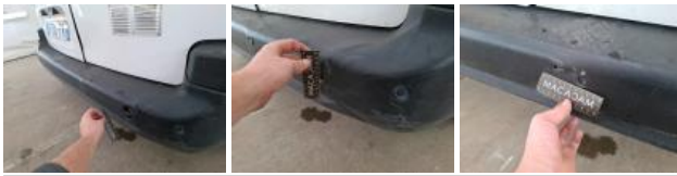
Capteur de parking AR, Cassé, E - Remplacer
