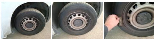
Jante tôle AVD, Déformé / Forcé, E - Remplacer
