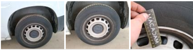
Jante tôle ARG, Déformé / Forcé, Acceptable
