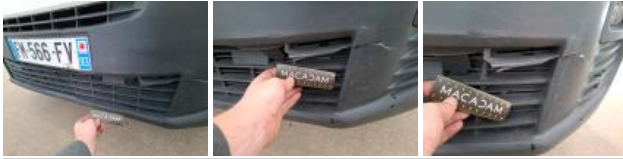
Pare-chocs AV, Cassé, E - Remplacer
