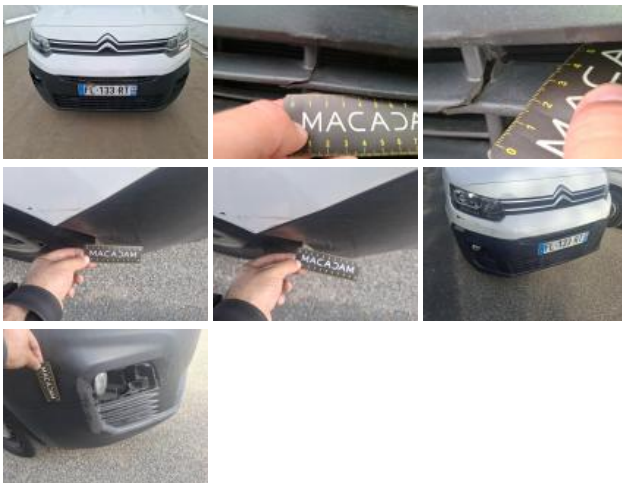
Moulure de pare-chocs AVD, Manque, E - Remplacer
