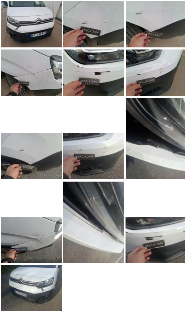
Pare-chocs AV, Cassé, E - Remplacer
