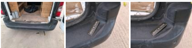
Joint de porte AR, Déchirure, E - Remplacer
