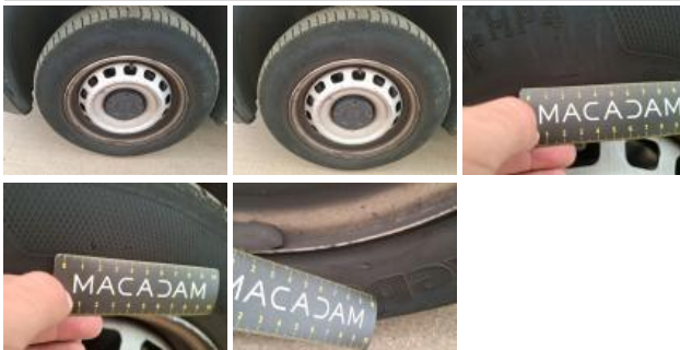
Jante tôle AVD, Déformé / Forcé, E - Remplacer
