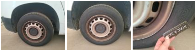
Jante tôle AVD, Déformé / Forcé, E - Remplacer
