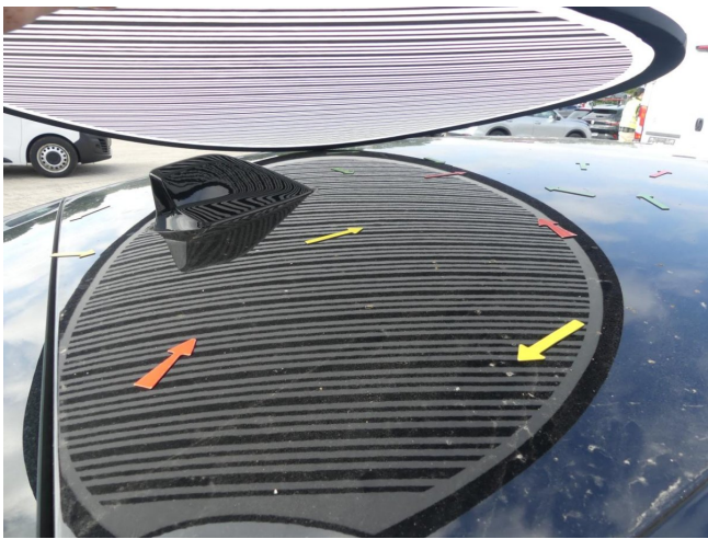
Dach - Hagelschaden - Dellen drücken
