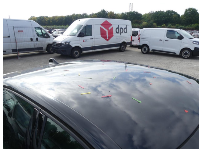
Dach - Hagelschaden - Dellen drücken
