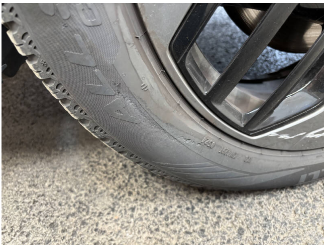
Reifen VL Flanke beschädigt, Reifen VA - ersetzen
