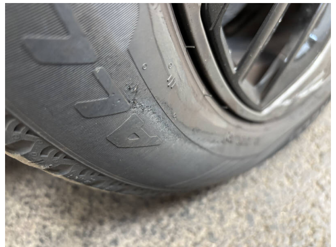
Reifen VL Flanke beschädigt, Reifen VA - ersetzen
