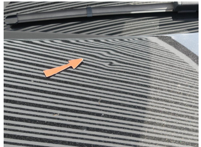
Motorhaube - instandsetzen und lackieren
