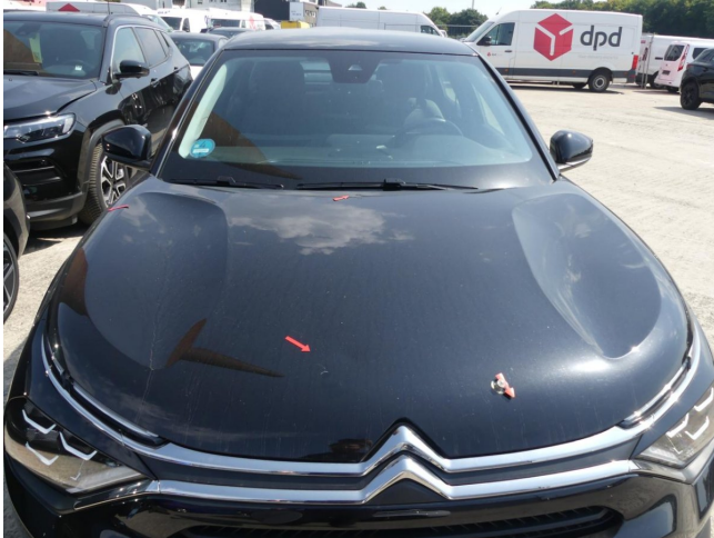
Motorhaube - instandsetzen und lackieren
