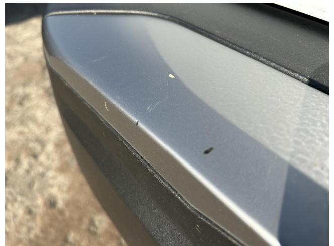
Blende Stoßfänger hinten - Kratzer - erneuern
