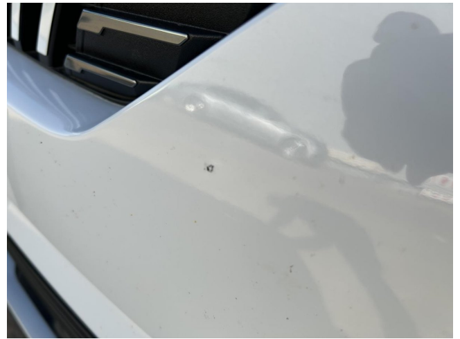
Stoßfänger vorne - Steinschlag - lackieren
