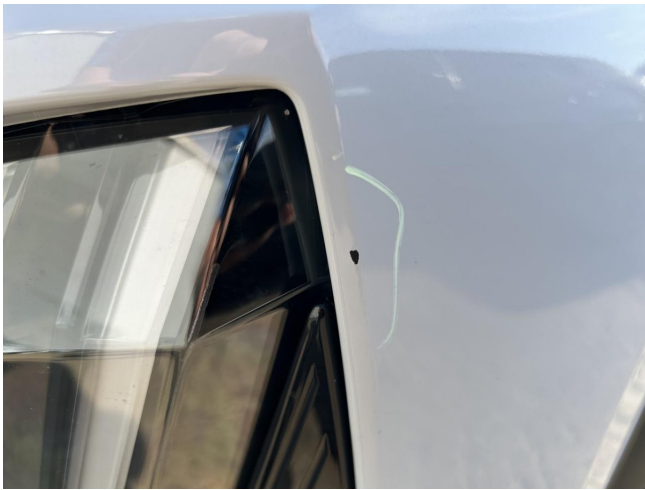
Stoßfänger vorne - Steinschlag - lackieren
