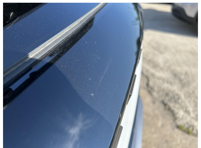
Blende Heckklappe - Kratzer - erneuern
