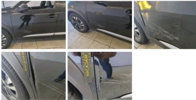
Deur V L sierlijst, Vervormd / Geforceerd, Vervangen
