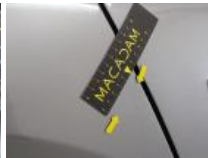
Porte AVD, Griffe(s), LI - Réparer et peindre (complet)
