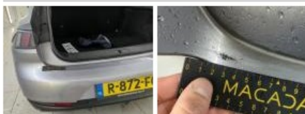
Kentekenplaat A, Vervormd / Geforceerd, Vervangen
