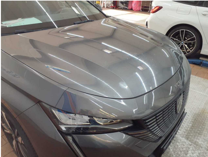
Damage 5: Bonnet: Bonnet (Verätzungen) - Paint defect - Lacquer
