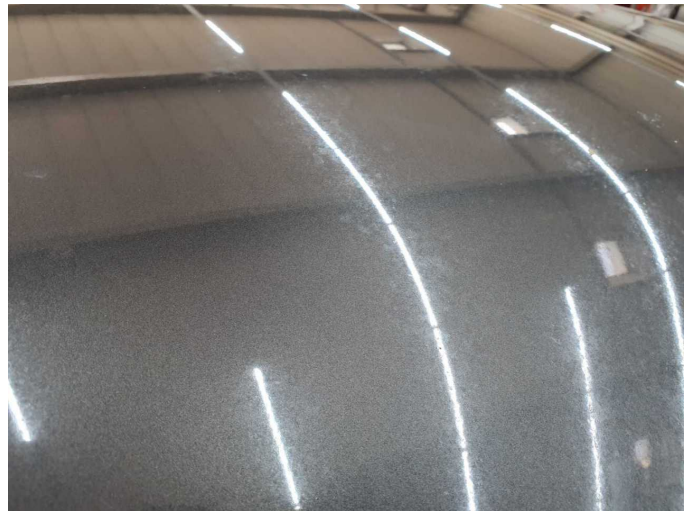
Damage 5: Bonnet: Bonnet (Verätzungen) - Paint defect - Lacquer
