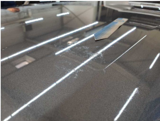
Damage 7: Roof: Roof (Verätzungen) - Paint defect - Lacquer
