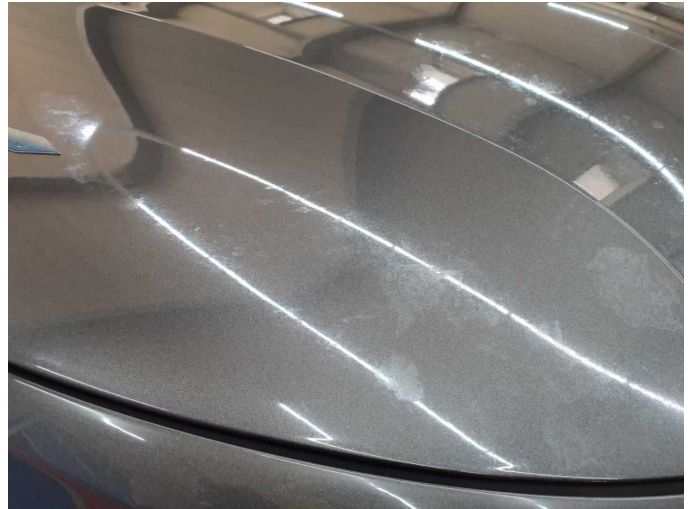
Damage 5: Bonnet: Bonnet (Verätzungen) - Paint defect - Lacquer
