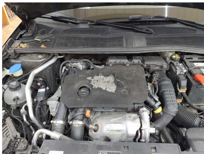
Beschädigung 3: Motor: Motorabdeckung - beschädigt - erneuern
