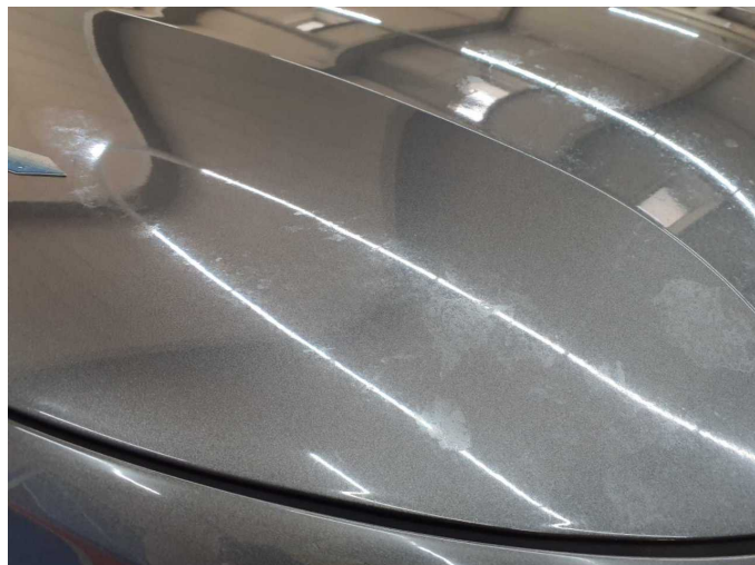
Beschädigung 5: Motorhaube: Motorhaube (Verätzungen) - Lackmangel - Oberflächenlack
