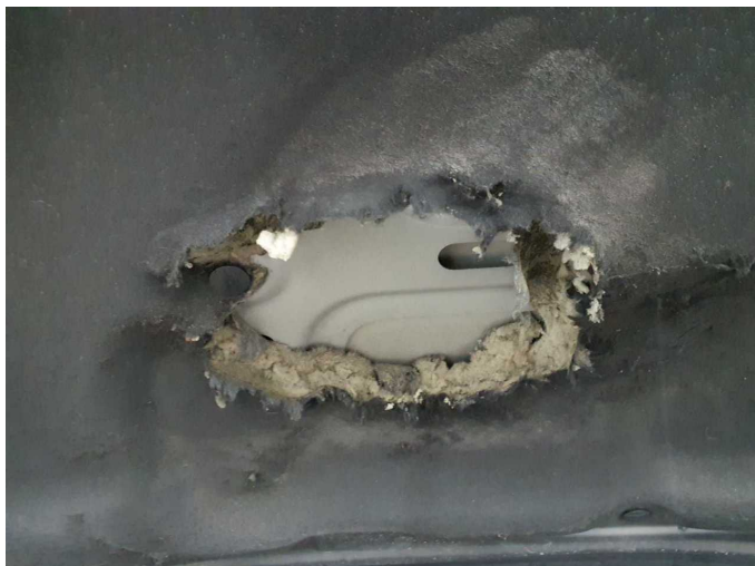
Beschädigung 1: Motorhaube: Dämmmatte - beschädigt - erneuern
