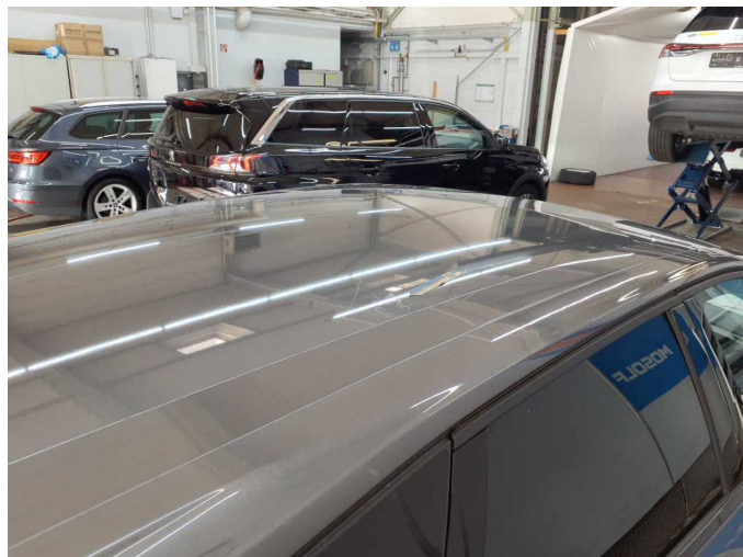
Beschädigung 7: Fahrzeugdach: Dach (Verätzungen) - Lackmangel - Oberflächenlack
