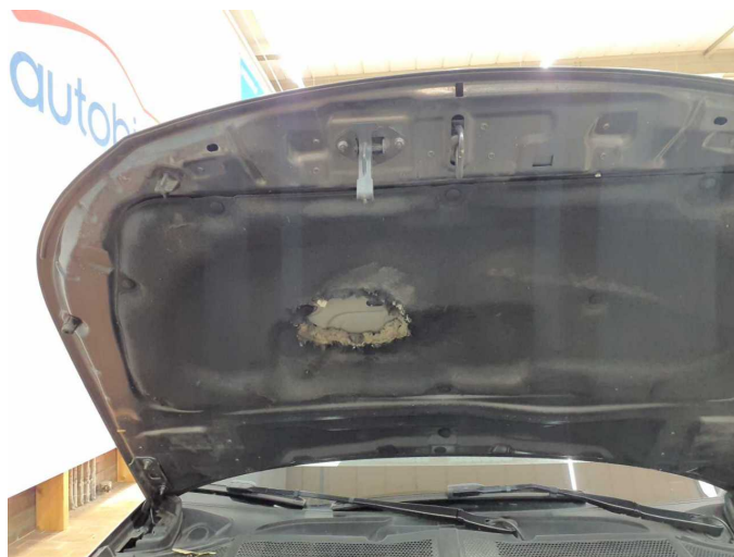
Beschädigung 1: Motorhaube: Dämmmatte - beschädigt - erneuern
