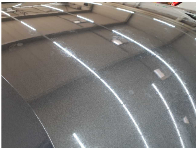
Beschädigung 5: Motorhaube: Motorhaube (Verätzungen) - Lackmangel - Oberflächenlack
