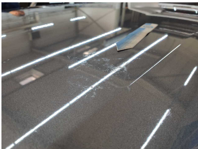
Beschädigung 7: Fahrzeugdach: Dach (Verätzungen) - Lackmangel - Oberflächenlack
