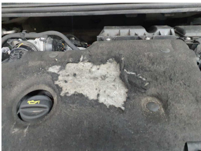
Beschädigung 3: Motor: Motorabdeckung - beschädigt - erneuern
