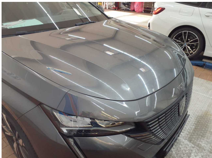
Beschädigung 5: Motorhaube: Motorhaube (Verätzungen) - Lackmangel - Oberflächenlack
