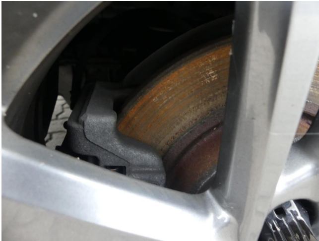
Bremsanlage - Bremsscheiben hinten Tragbild - erneuern
