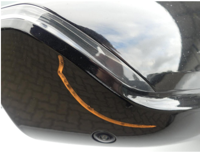
Außenspiegelgehäuse rechts - Spiegelkappe zerkratzt - lackieren
