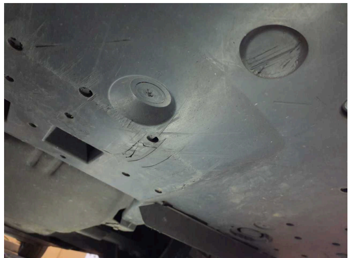
Damage 2: Body: Underbody panelling (+verkratzt) - Malposition - Un- / install
