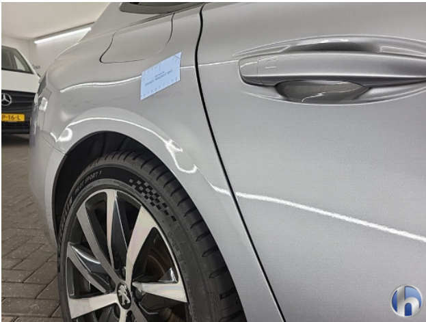
1. Zijwand - achter - rechts Gedeukt - Herstellen
