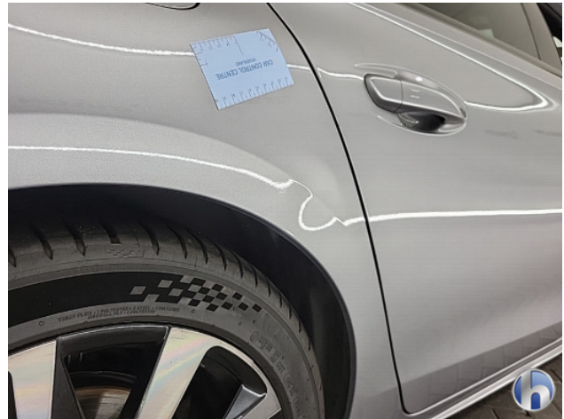
1. Zijwand - achter - rechts Gedeukt - Herstellen
