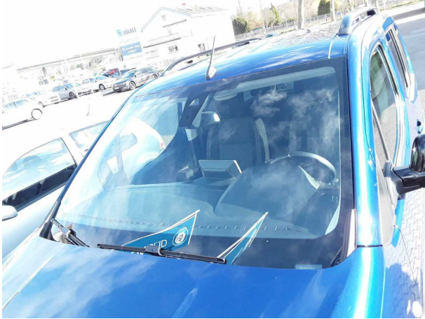
Beschädigung #4: Verglasung: Frontscheibe - Steinschlag - erneuern
