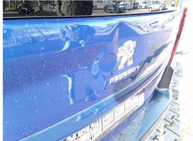
Beschädigung #5: Heckklappe/-tür: Heckklappe - verformt - erneuern
