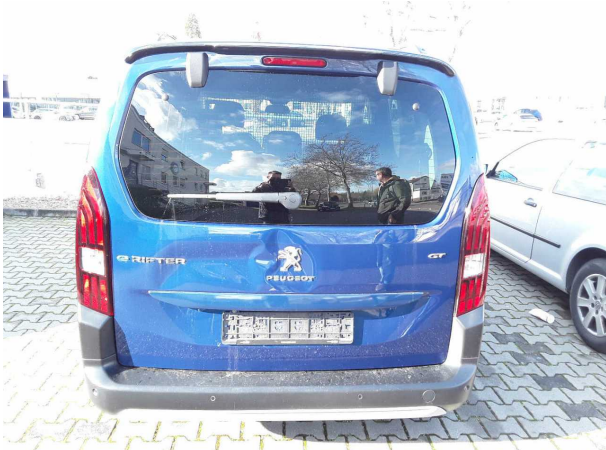
Beschädigung #5: Heckklappe/-tür: Heckklappe - verformt - erneuern
