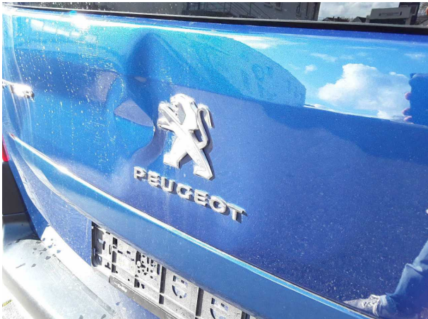
Beschädigung #5: Heckklappe/-tür: Heckklappe - verformt - erneuern
