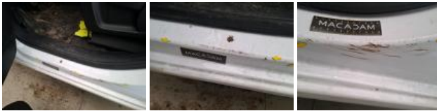
Joint de porte AVG, Déchirure, E - Remplacer
