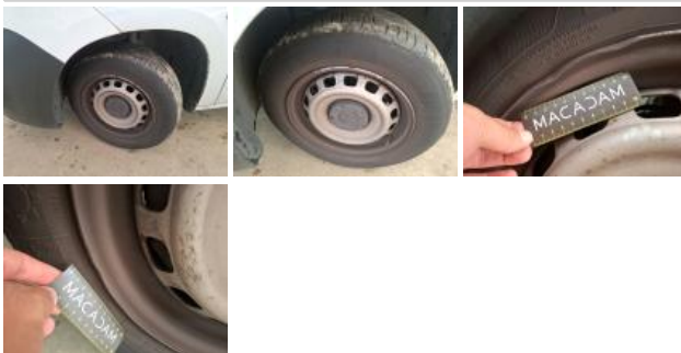
Jante tôle ARG, Déformé / Forcé, E - Remplacer
