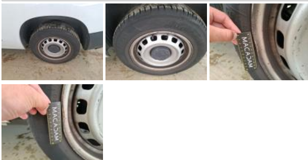
Jante tôle AVD, Déformé / Forcé, E - Remplacer
