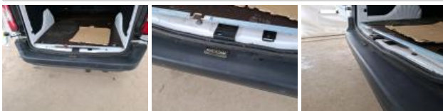
Pare-chocs AR, Déformé / Forcé, E - Remplacer
