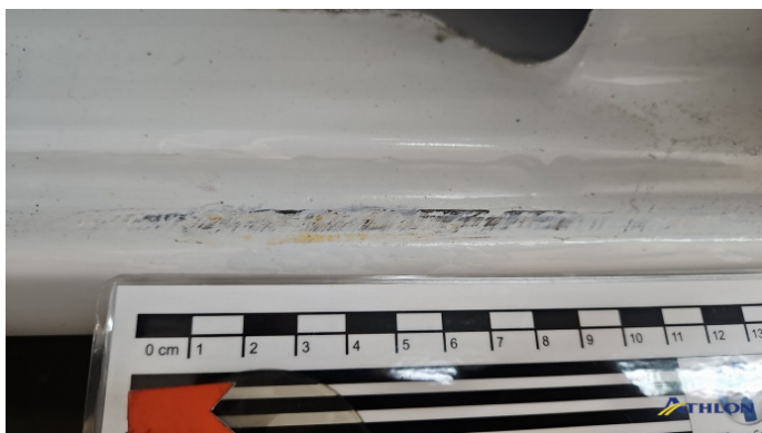
14. Schweller - Rechts Kratzer Ab 60mm
