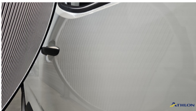
19. Tür Vorne - Rechts Verformt (leicht)
