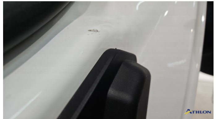
9. Türeinstieg Hinten - Links Verformt (leicht)
