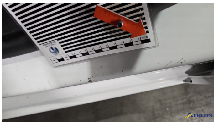
6. Türeinstieg Vorne - Links Kratzer Ab 60mm
