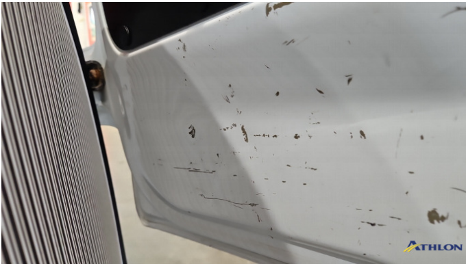
12. Hecktür Rechts Verformt (leicht)
