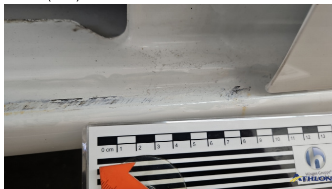
14. Schweller - Rechts Kratzer Ab 60mm
