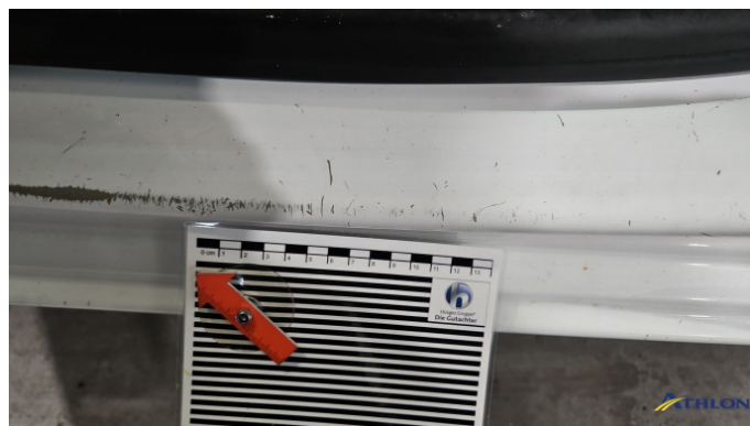
6. Türeinstieg Vorne - Links Kratzer Ab 60mm
