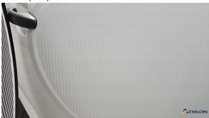
19. Tür Vorne - Rechts Verformt (leicht)
