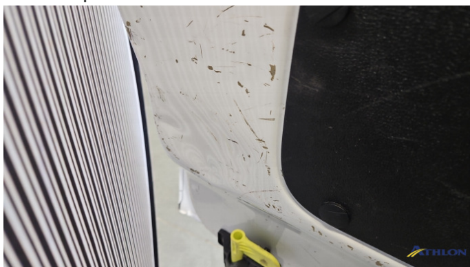
25. Hecktür Links Verformt (leicht)
