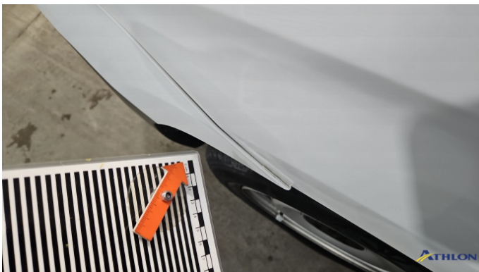
4. Stoßfänger Vorne Spaltmaß Ungenau
