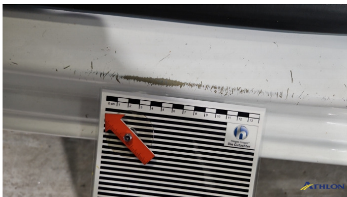
6. Türeinstieg Vorne - Links Kratzer Ab 60mm
