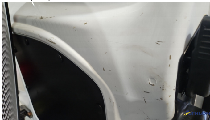
12. Hecktür Rechts Verformt (leicht)
