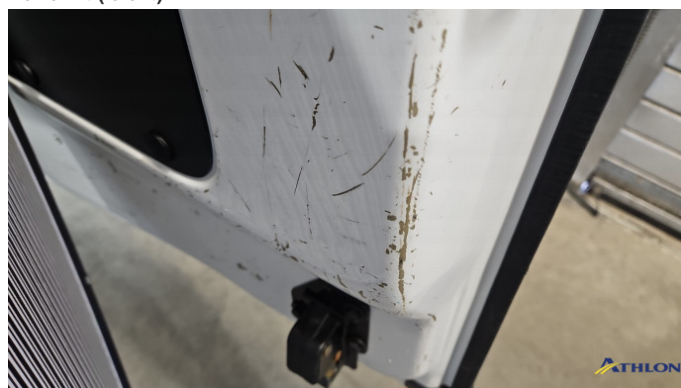
12. Hecktür Rechts Verformt (leicht)
