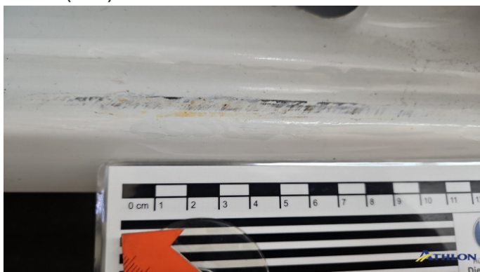
14. Schweller - Rechts Kratzer Ab 60mm
