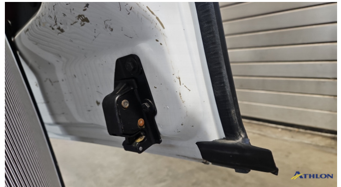
12. Hecktür Rechts Verformt (leicht)
