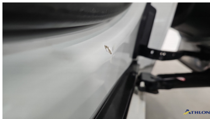
9. Türeinstieg Hinten - Links Verformt (leicht)
