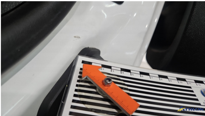
9. Türeinstieg Hinten - Links Verformt (leicht)
