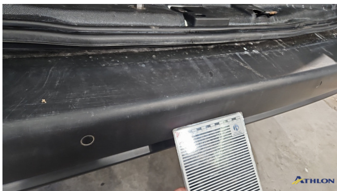
13. Stoßfänger Hinten Kratzer
