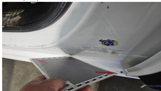
6. Türeinstieg Vorne - Links Verformt (leicht)
