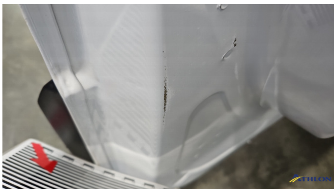
7. Tür Vorne - Links Verformt (leicht)
