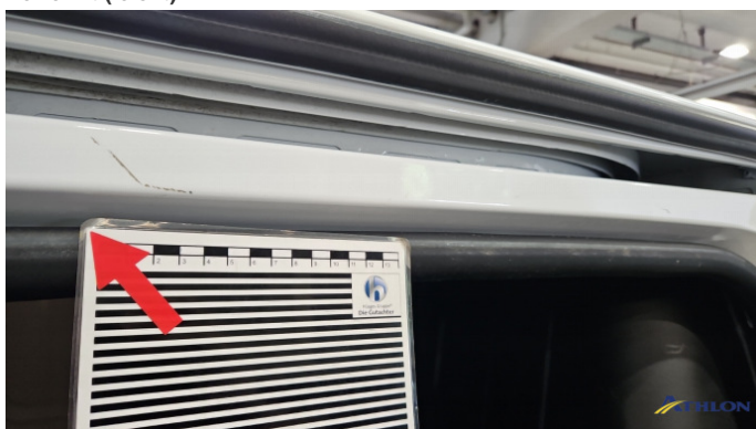
17. Türeinstieg Hinten - Rechts Kratzer
