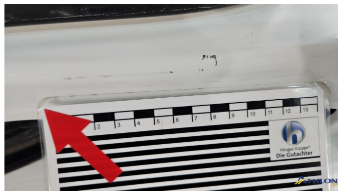
17. Türeinstieg Hinten - Rechts Kratzer
