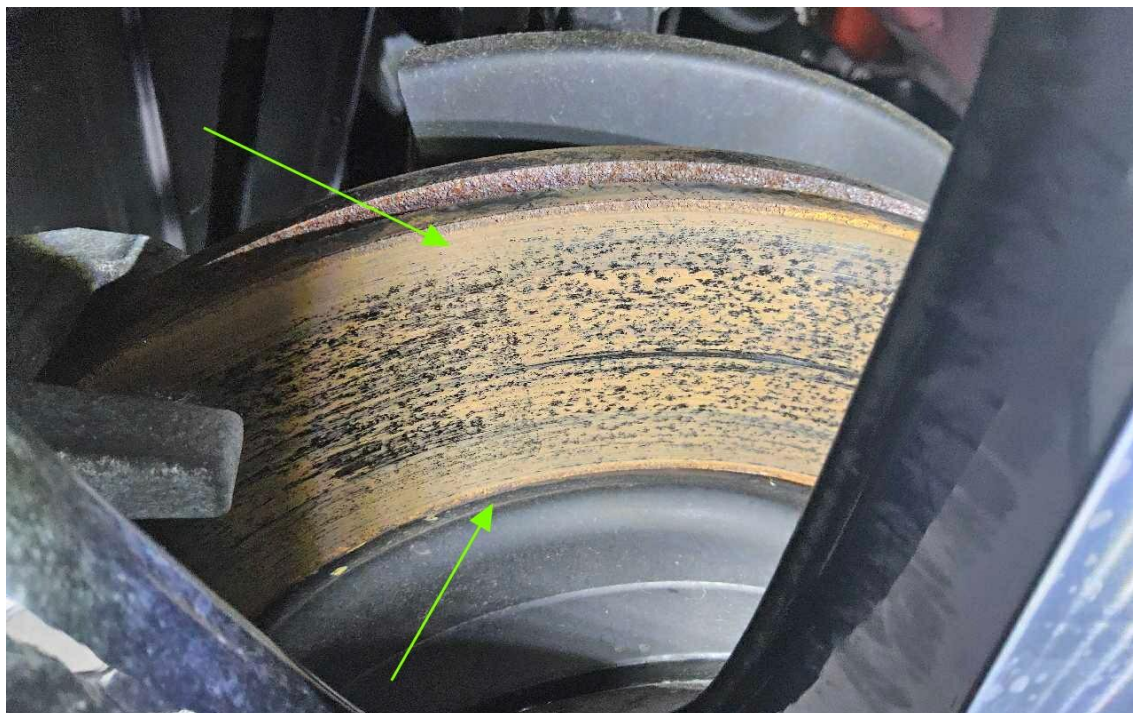
Bild 23 : starke Korrosionsbildung Bremse vorne und hinten
